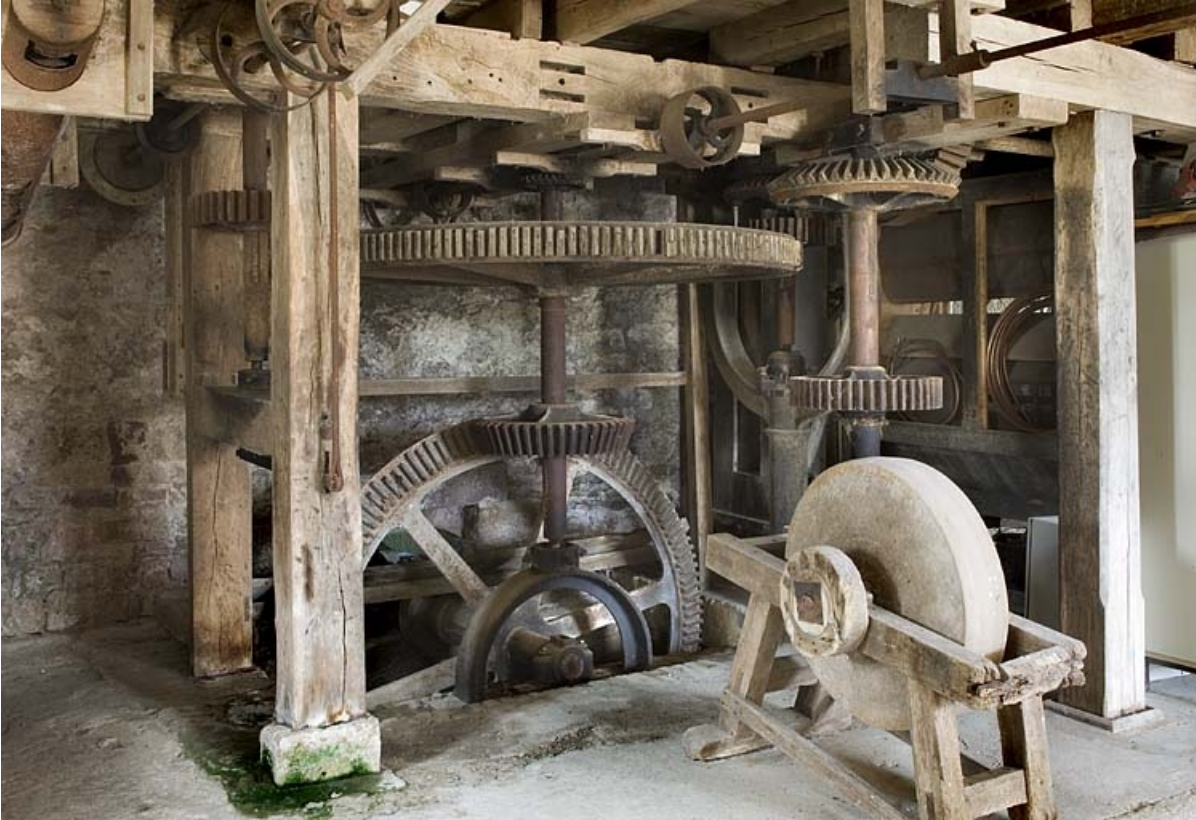
Belfroi du moulin, avec ses transmissions par engrenages.
