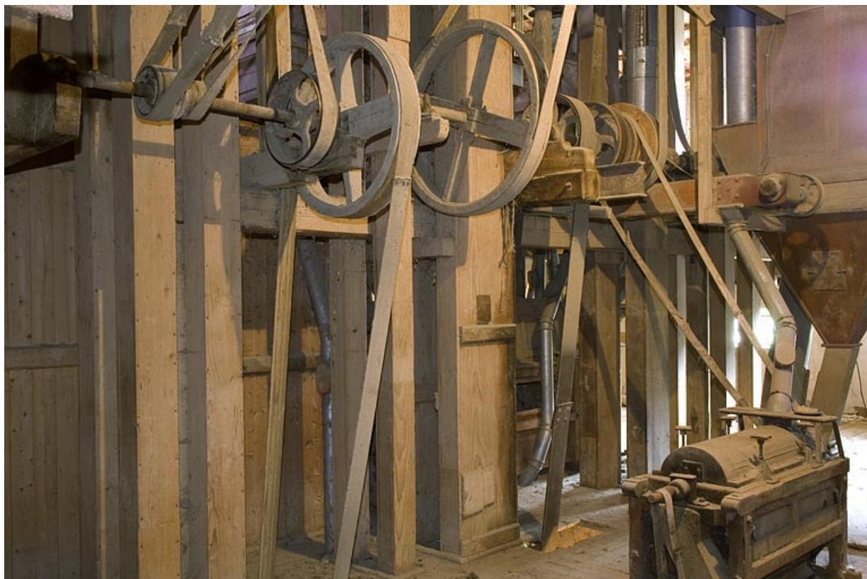
Système d'élévation, poulies, courroies et brosse à son (2e étage).
