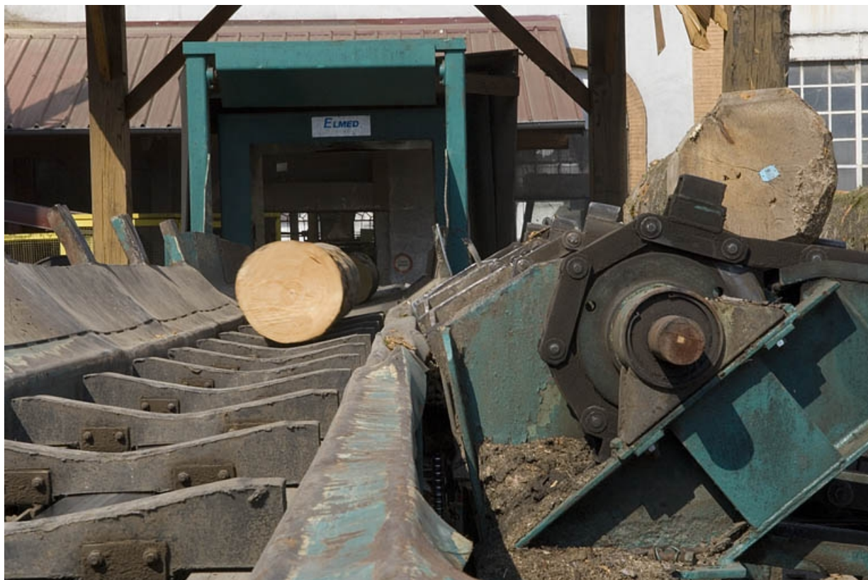
Admission d'une grume pour écorçage. 70, Ronchamp, 43 rue des Mineurs
