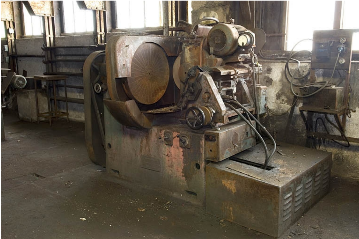
Rectifieuse de lames de scie, dite machine à planer Engeländer et Beyer (Remscheid). 70, Haut-du-Them-Château-Lambert, 4 impasse des Maîtres de Forge
