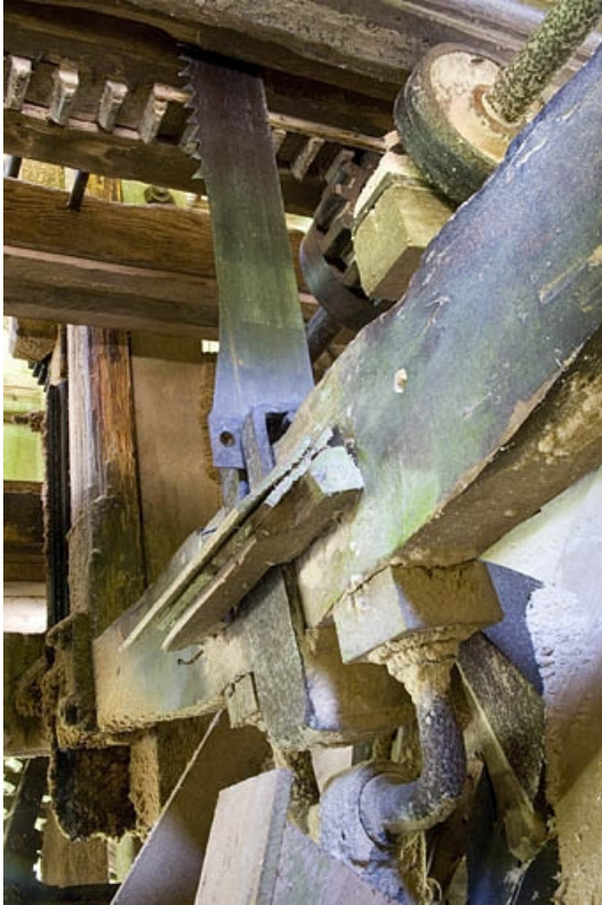
Etage de soubassement. Détail de la transmission : manivelle et lame de la scie vues du dessous. 70, Servance, lieudit : la Grève
