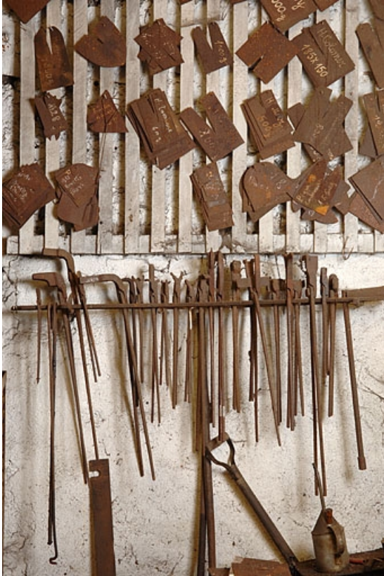
Forge du Bas. Modèles et pinces situés à proximité du laminage.
