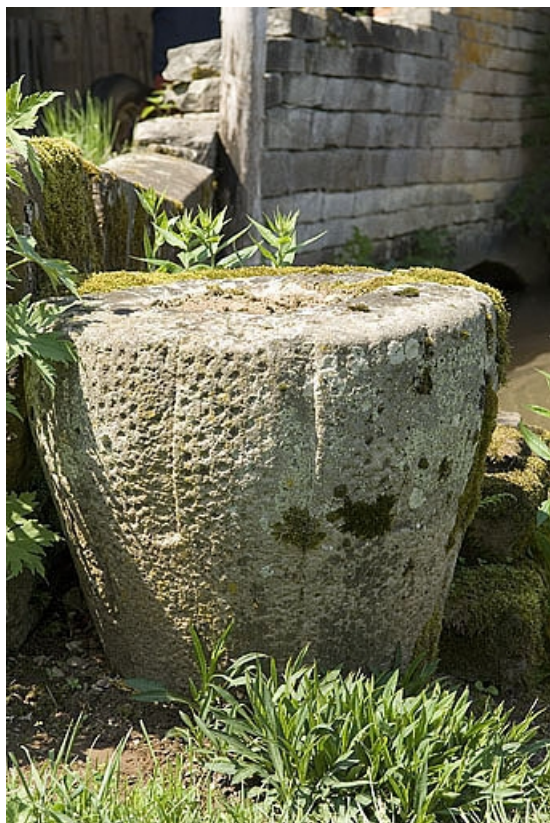
Meule déposée de la ribe (appelée poire).
