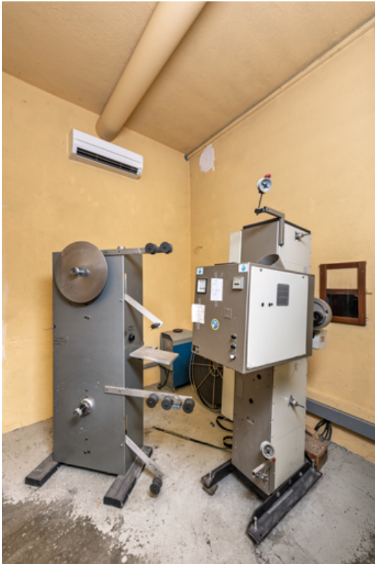
Projecteur argentique Kinoton FP 30 et dérouleur de film. 58, Luzy, 9 rue des Remparts
