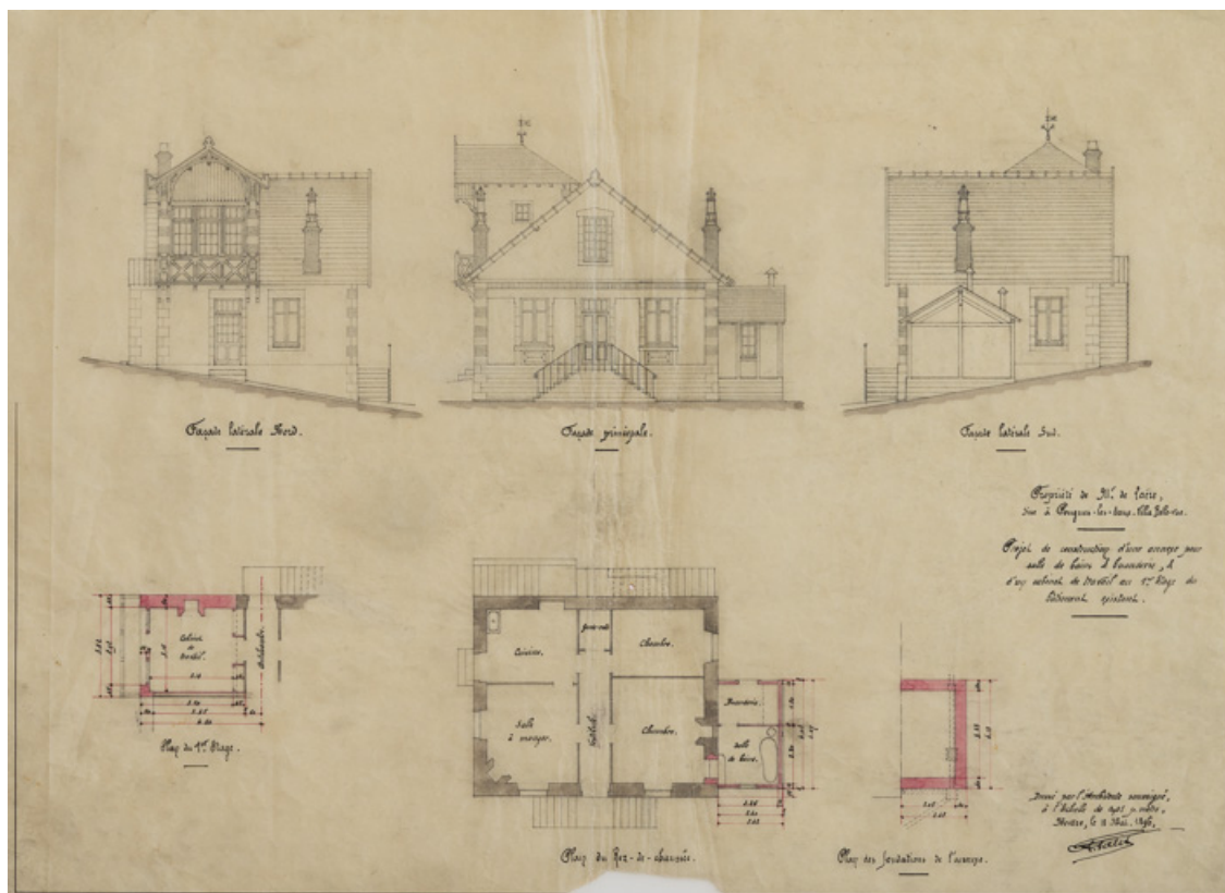
Projet de cabinet de travail dans la lucarne pignon à construire au-dessus de la cuisine, plans et élévations. 58, Pougues-les-Eaux, 93 avenue de Paris
