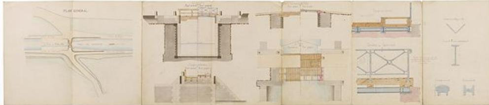
"**Projet de remplacement du tablier en charpente par un tablier métallique. Pont sur l'écluse de Marré n°10". Plan général, élévations et coupe du pont actuel et du pont projeté. Détail des garde-corps en métal.** (Dessin ; 7 feuilles de 21 x 31 cm ; juillet 1874, Archives VNF-direction territoriale Centre-Bourgogne ; subdivision de Corbigny)
