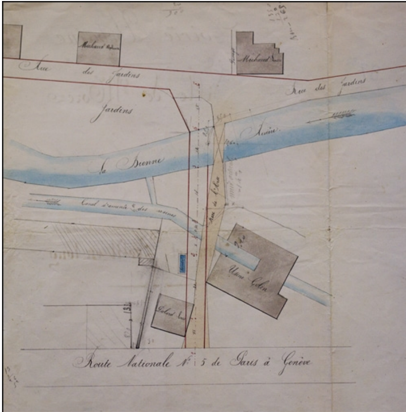
Rectification de la rue de l'Arse et établissement d'un pont et d'un ponceau pour son passage, 1878.
