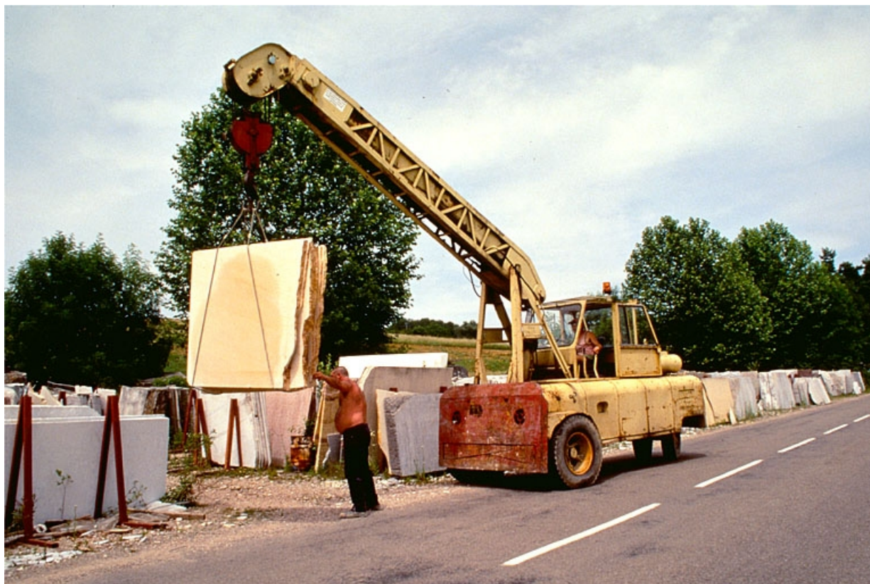
Transport de tranches de marbre avec la grue automotrice Belotti.
