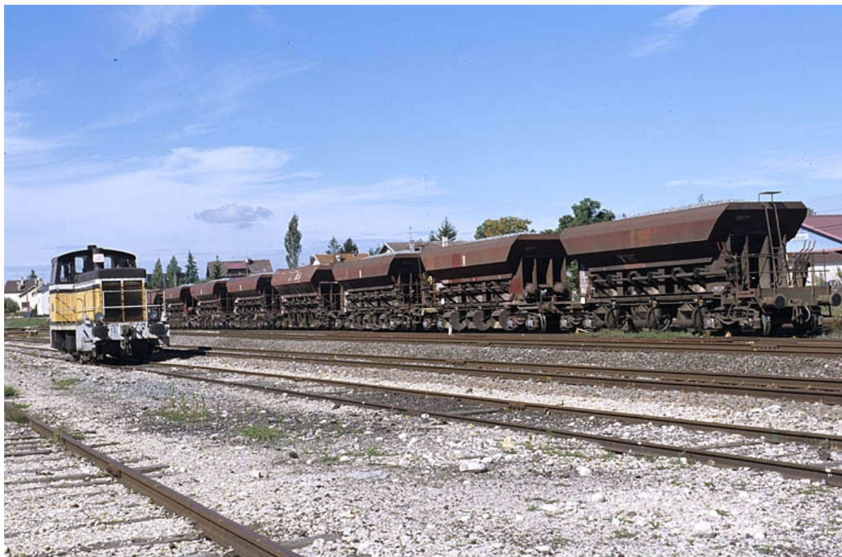
Locomotive diesel Y 7400 (n° Y 7435) et wagons-trémies.
