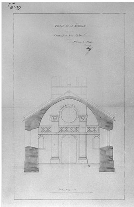
Construction d'un clocher : coupe transversale, 1849.
