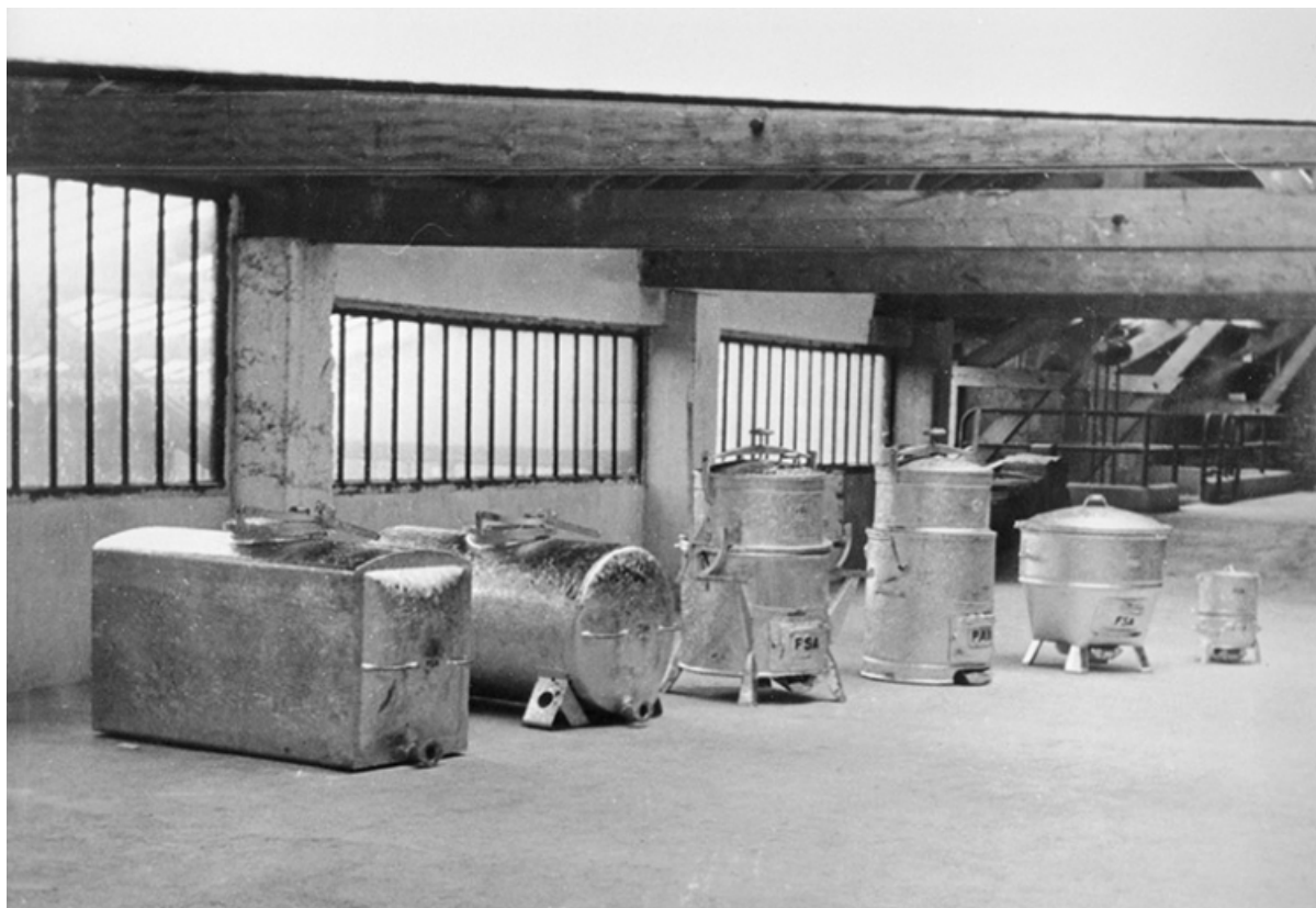
Réservoirs et chaudières à marmite F.S.A. dans l'atelier (D).
