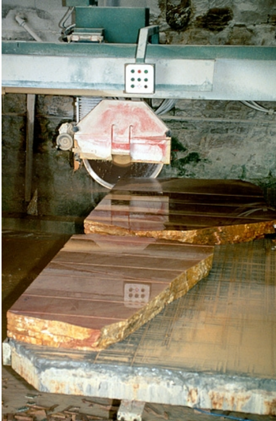
Débiteur Gregori en cours de sciage : vue de détail. 39, Balanod
