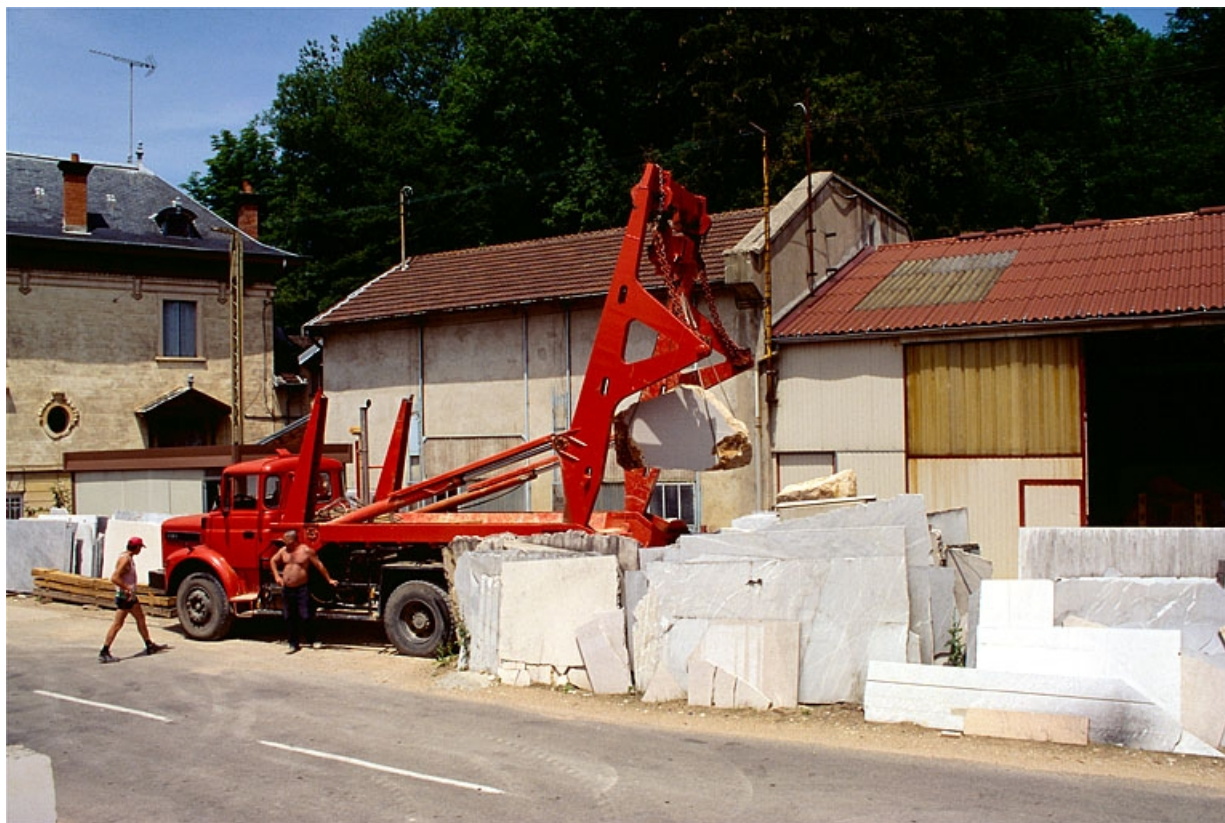
Déchargement d'un bloc de marbre de Balanod.
