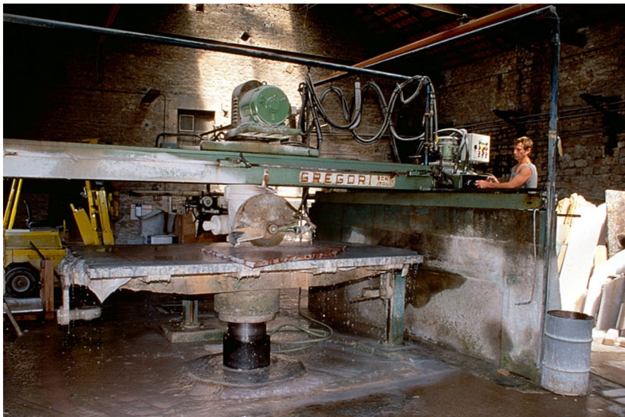
2e débiteuse Gregori en cours de sciage, avec ouvrier.
