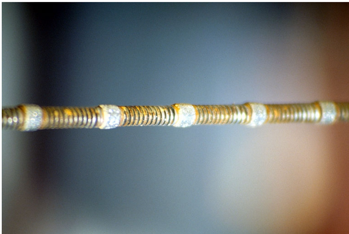
Scie à fil Ravet : détail du fil diamanté.
