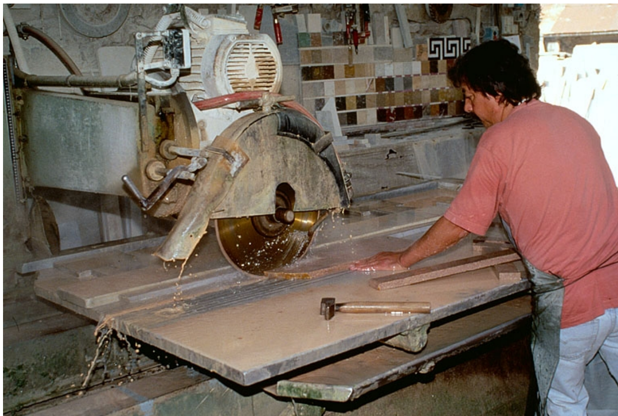
Débitage de plinthes en marbre de Balanod.
