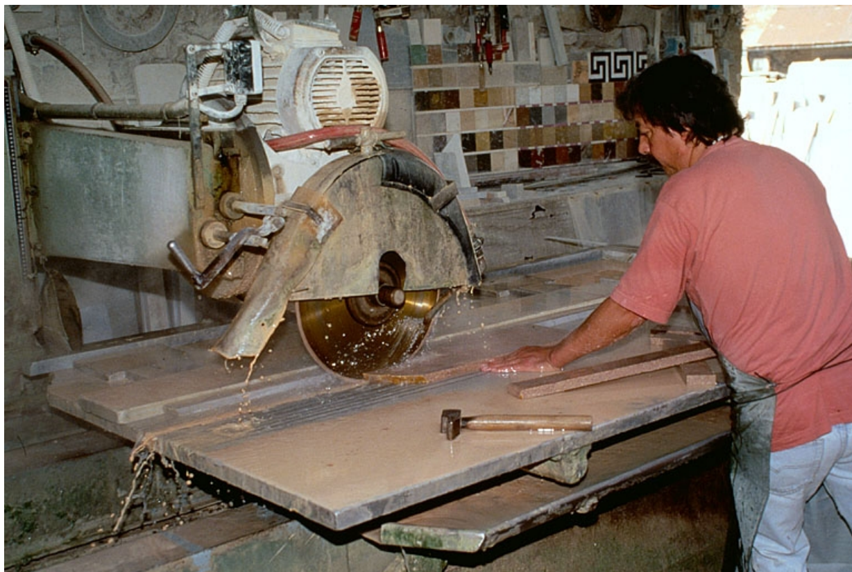
Débitage de plinthes en marbre de Balanod.
