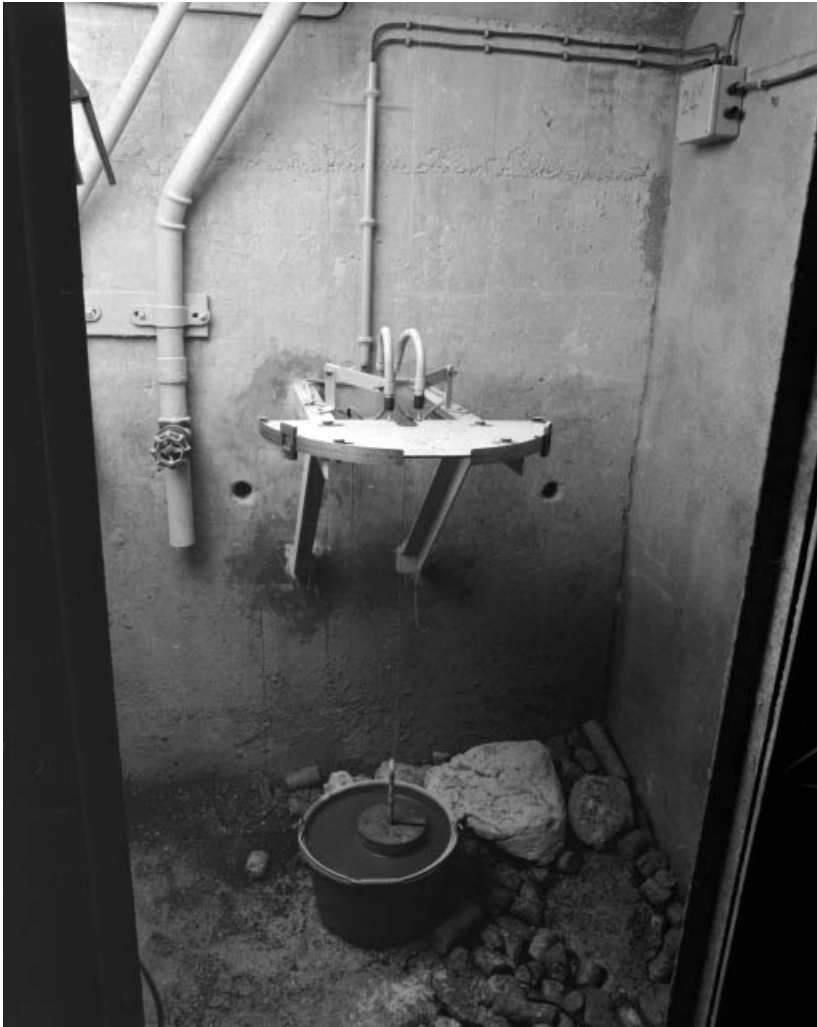
Système d'auscultation du barrage : pendule.
