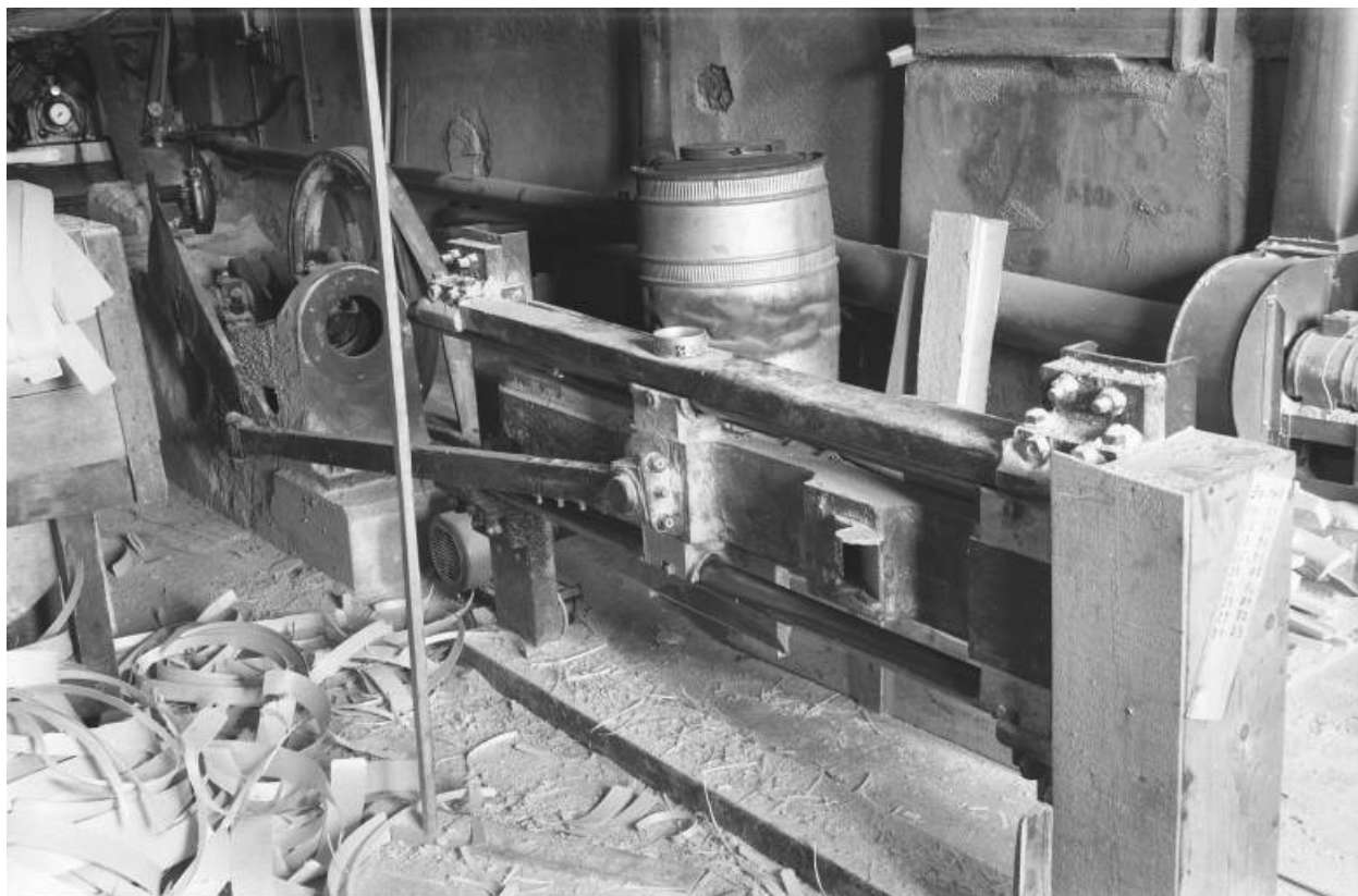
Vue d'ensemble de la targeuse, du côté de sortie des lanières de bois. Système moteur à gauche, rabot à droite. 39, Bois-d'Amont Grande Route 233
