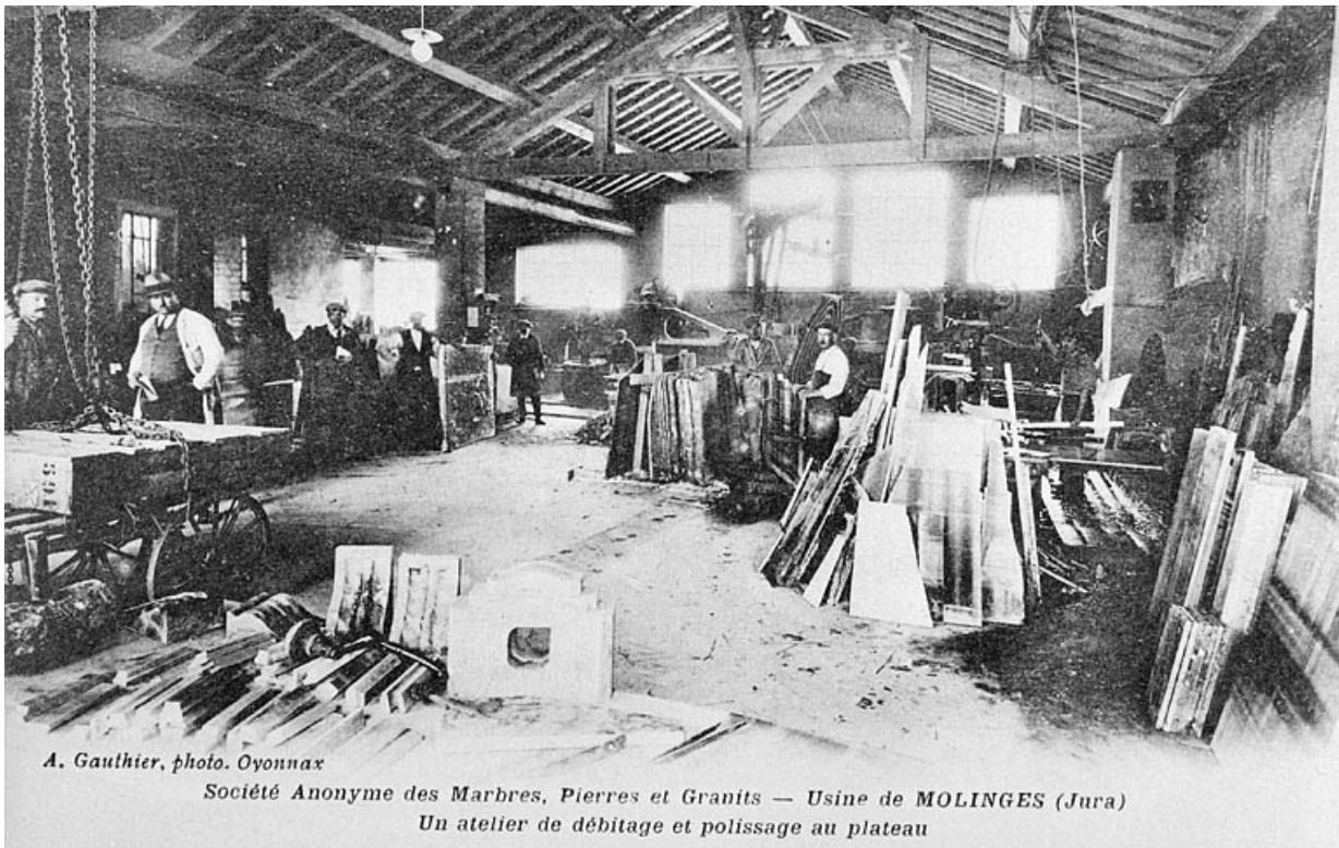
Société Anonyme des Marbres, Pierres et Granits - Usine de Molinges (Jura). Un atelier de débitage et polissage au plateau. 39, Molinges, lieu-dit : Moulin de Quettand
