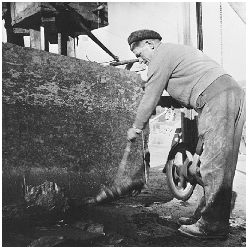
Suppression des aspérités sur la face d'un bloc taillé au fil hélicoïdal (vue rapprochée). 39, Chassal, lieudit : à la Carrière
