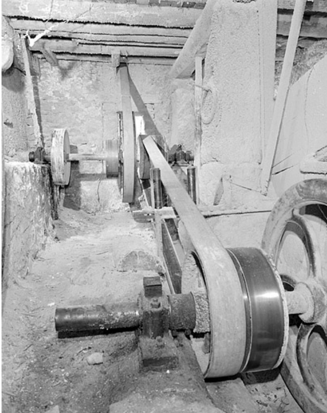
Renvoi de mouvement vers le chassis multiple.
