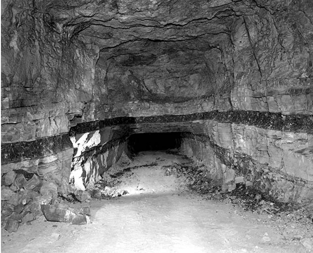
Passage du banc de gypse supérieur (dit n° 1) au banc inférieur (dit n° 3). Les couches sombres sont composées de marnes et de dolomies.
