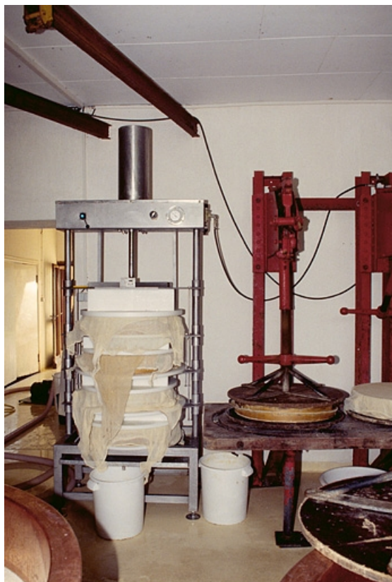
Presse pneumatique et presses à vis. 39, Arthenas
