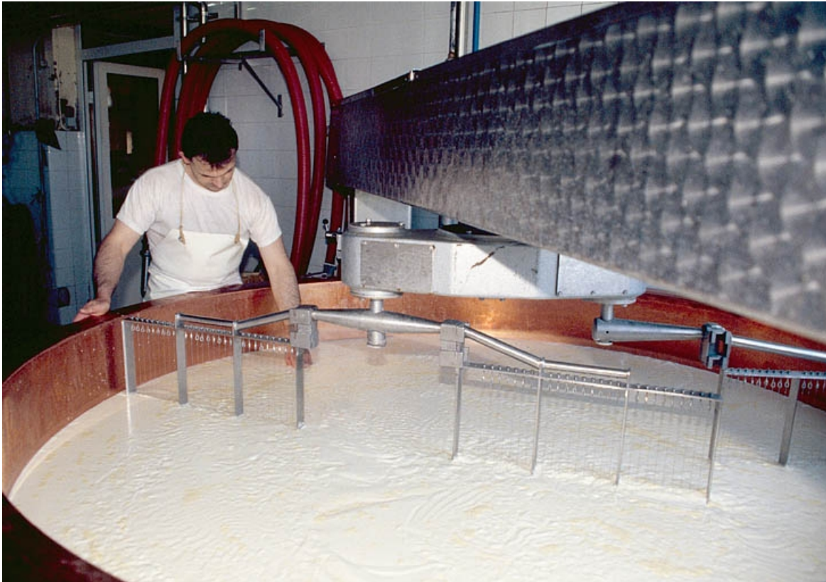
Vérification du décaillage, à la main.
