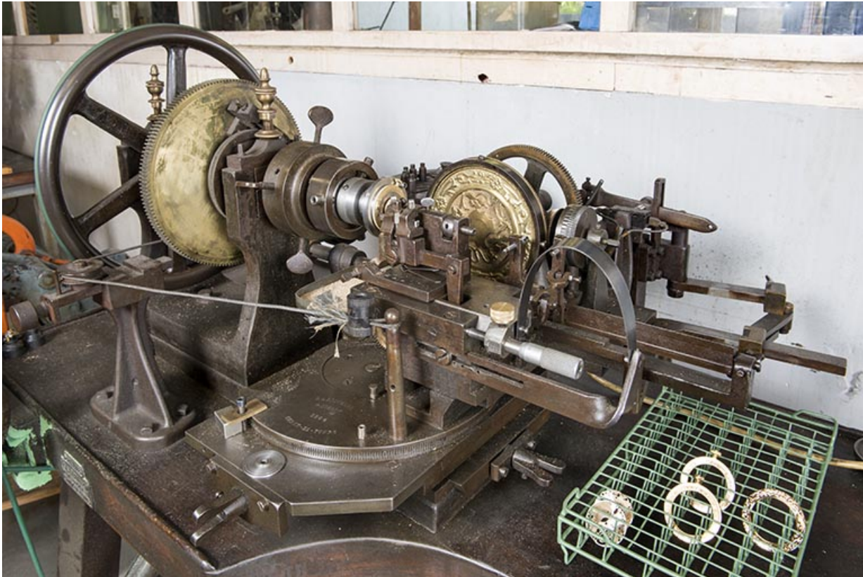
Machine à graver (machine à guillocher), par Lienhard à La Chaux-de-Fonds, 1904. 25, Charmauvillers, 23 Grande Rue
