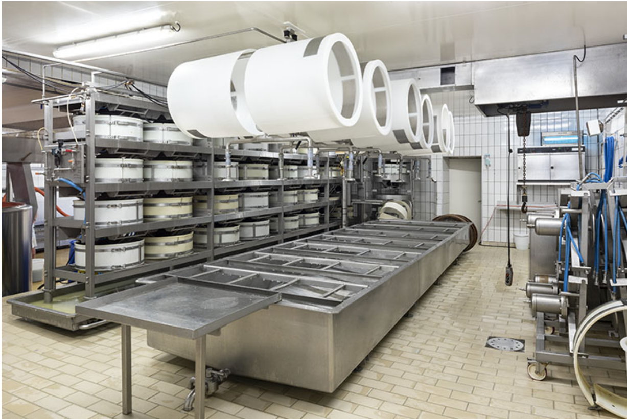
Intérieur de l'atelier de fabrication, avec l'installation de pressage à gauche. 25, Valoreille, 2 rue de l' Eglise
