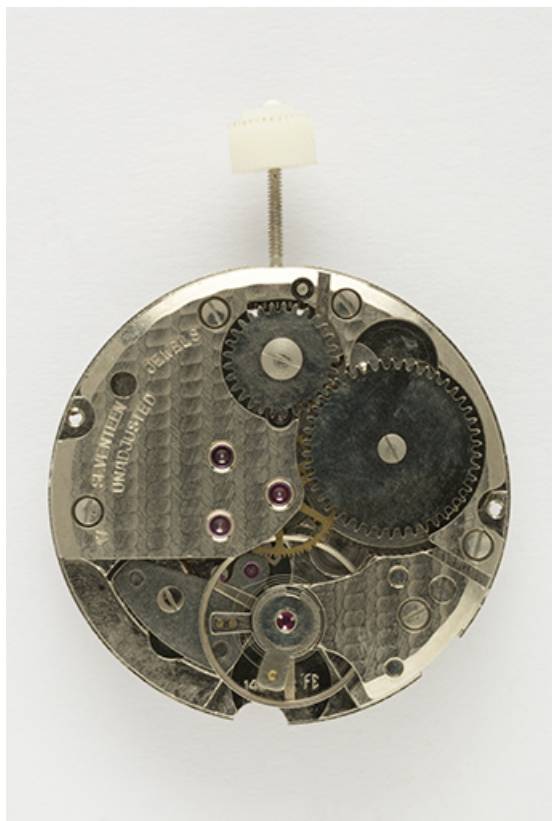
Mouvement de montre mécanique France Ebauches FE 140-C (côté ponts). 25, Villers-le-Lac
