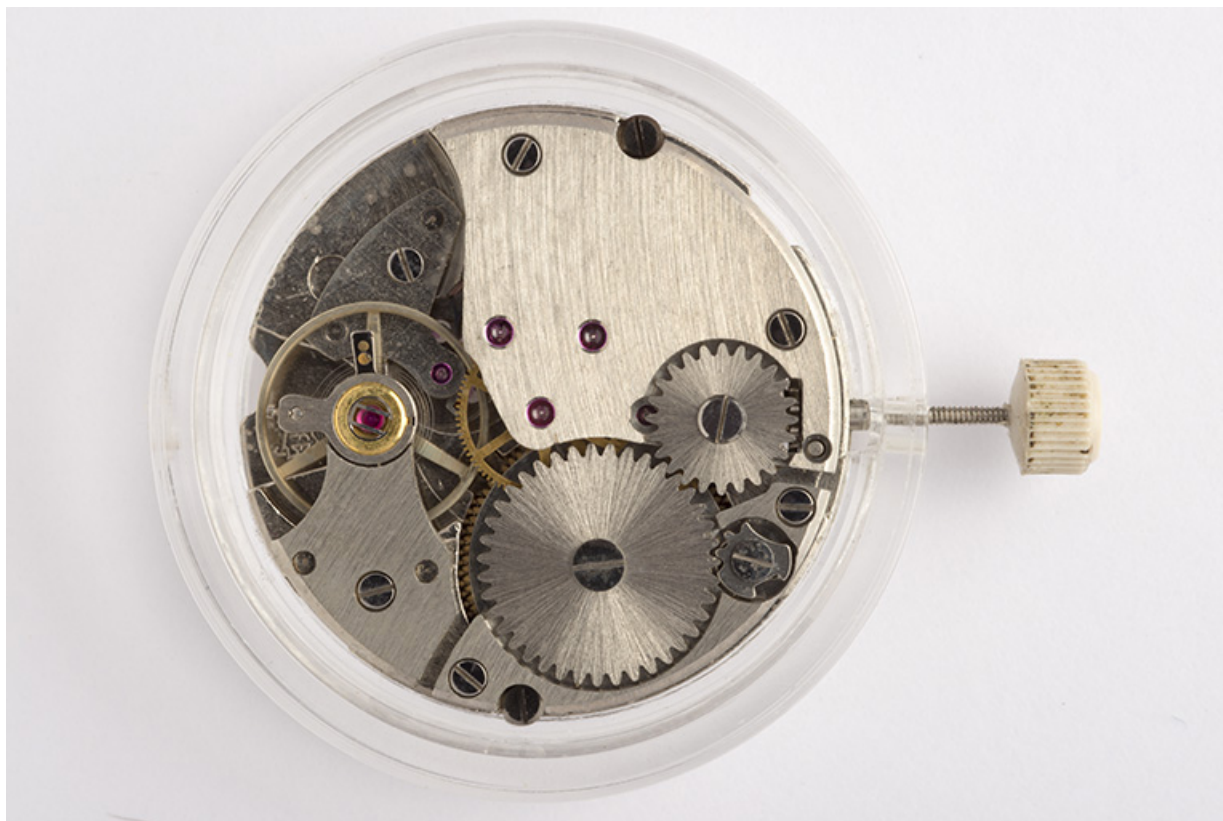
Mouvement de montre France Ebauches FE 140, fabriqué dans les années 1980 à Maïche. 25, Charquemont, 12 Rue Neuve
