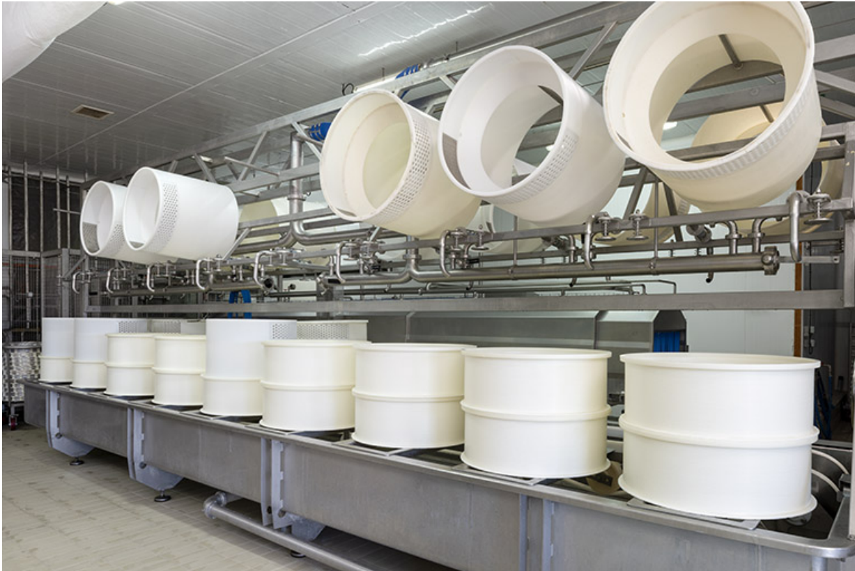
Atelier de fabrication : installation de soutirage et moulage.
