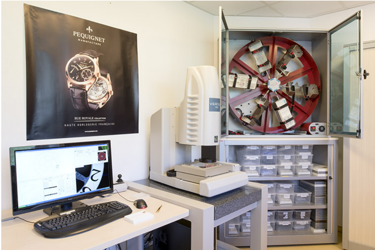
Laboratoire : machine de contrôle optique Micro.Vu (Vertex 120) et simulateur de mouvements VOH (Twistest). 25, Morteau, 1 rue du Bief
