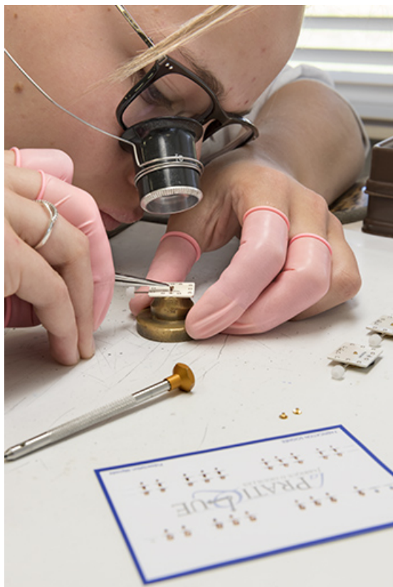
Horlogère à l'établi : pose des aiguilles.
