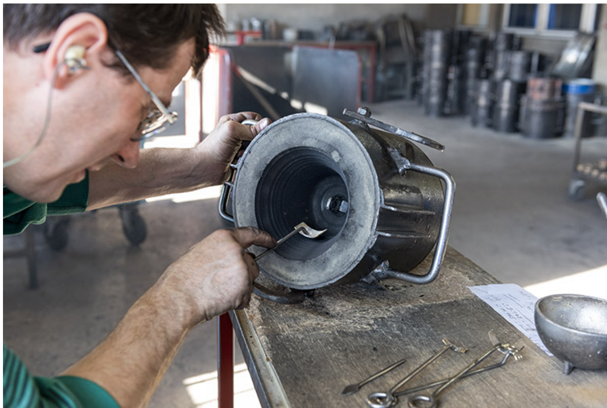
Fabrication du moule : impression d'une inscription dans le moule en creux. 25, Les Fins, 4 route de Morteau
