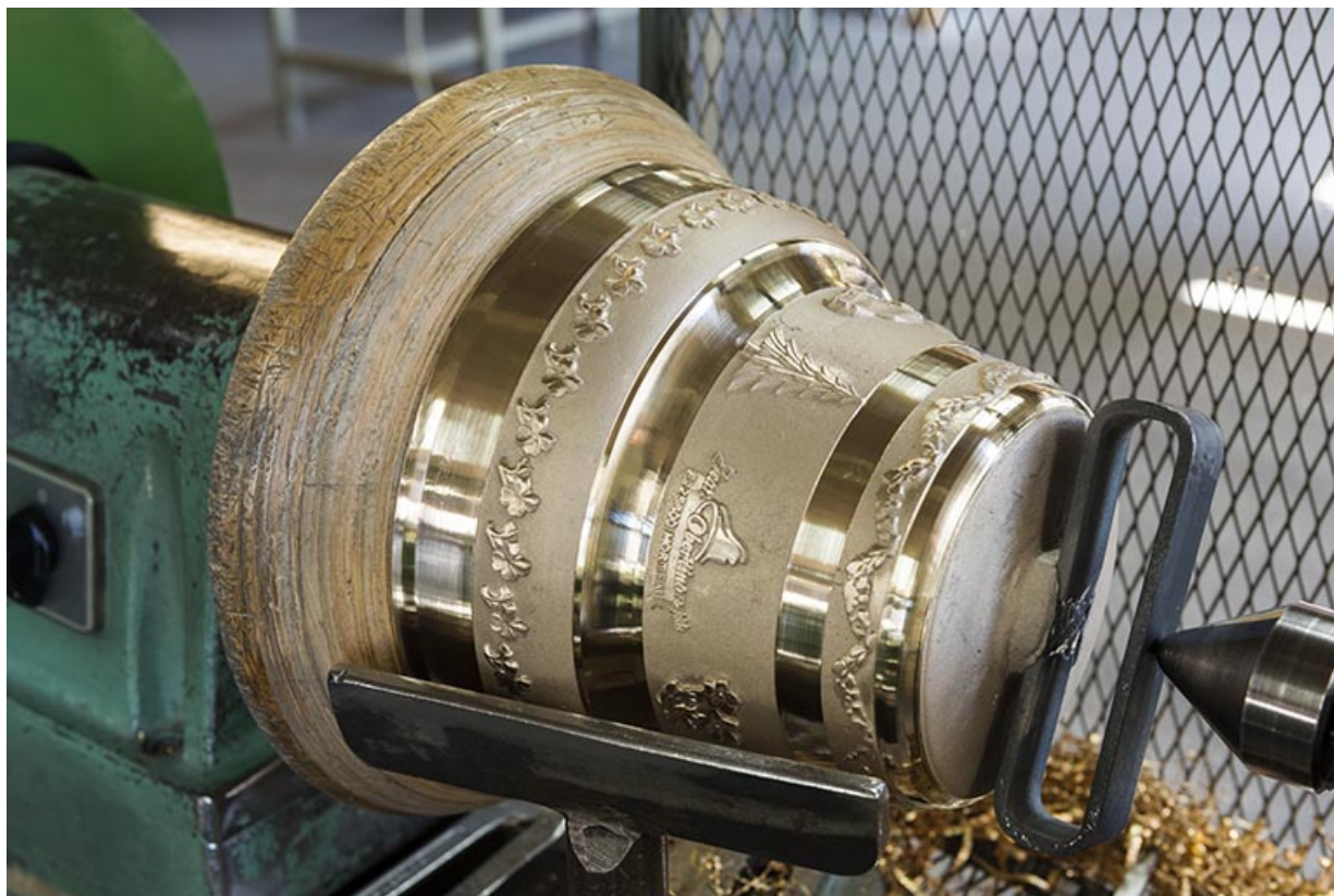
Tournage d'une cloche : la cloche immobile, avec ses bandes avivées par le ciseau.
