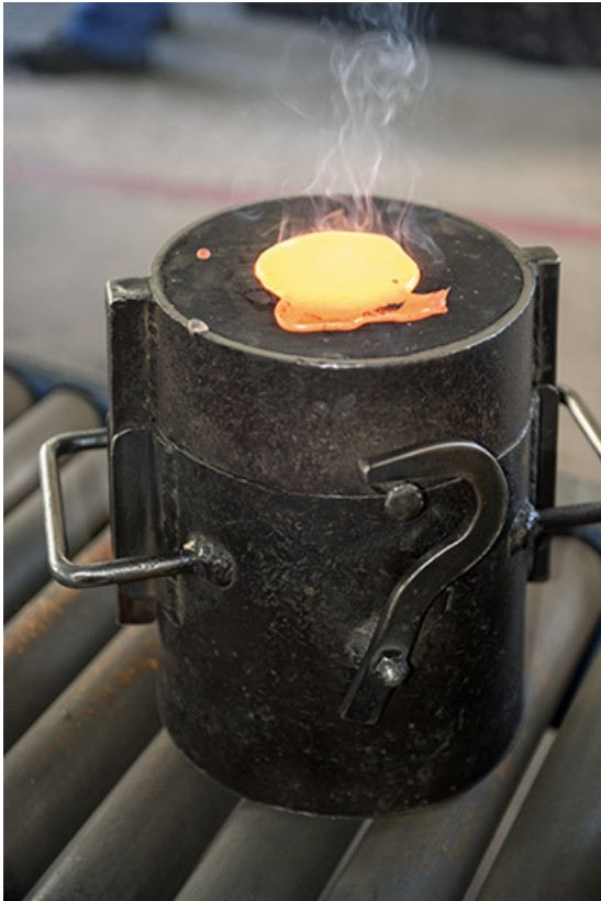
Refroidissement du bronze dans un petit châssis.
