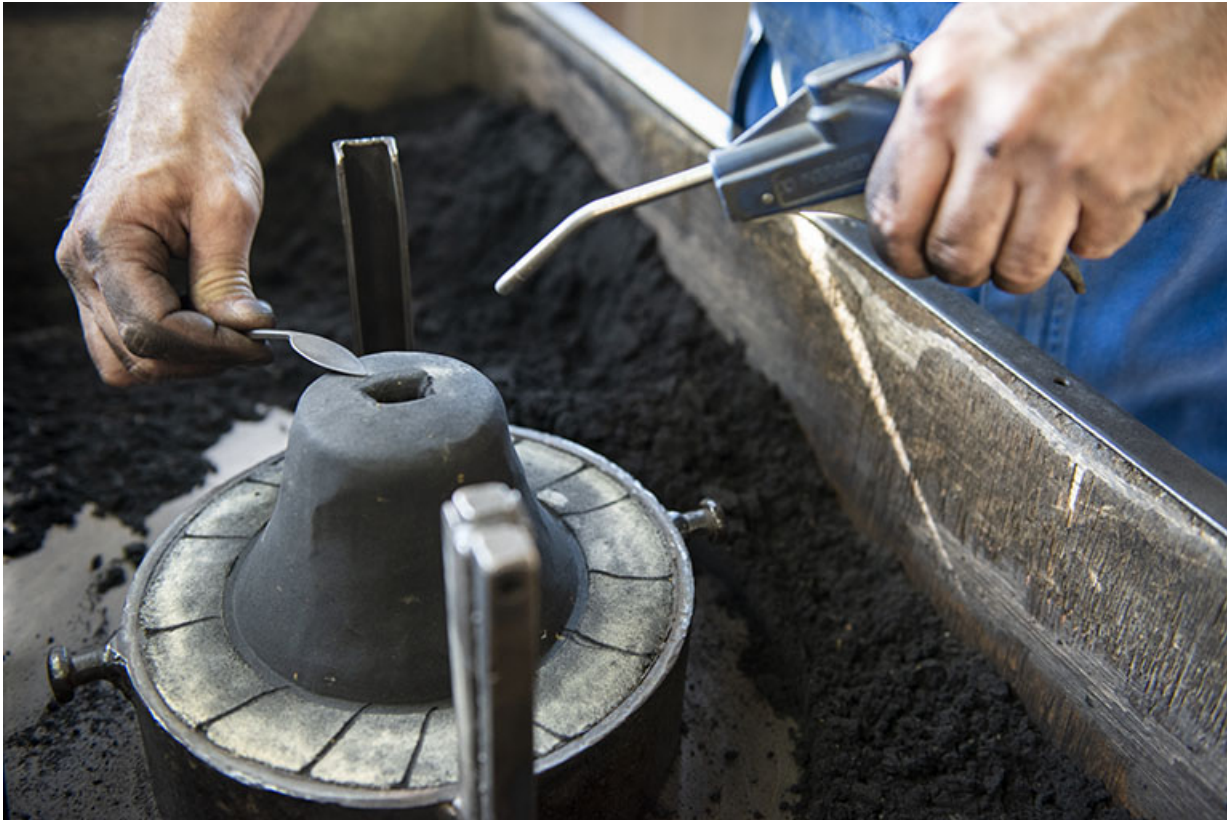
Fabrication du moule : finition du moulage en relief (intérieur de la cloche) une fois le modèle retiré.
