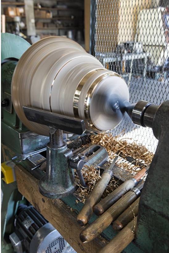
Tournage d'une cloche : la cloche en rotation.
