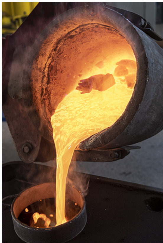
Coulée dans un grand châssis.
