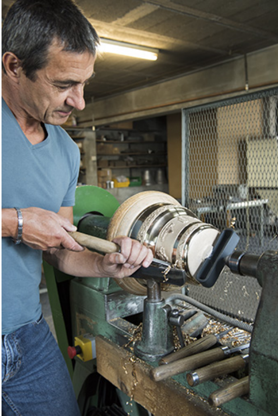
Tournage d'une cloche : geste de l'ouvrier.
