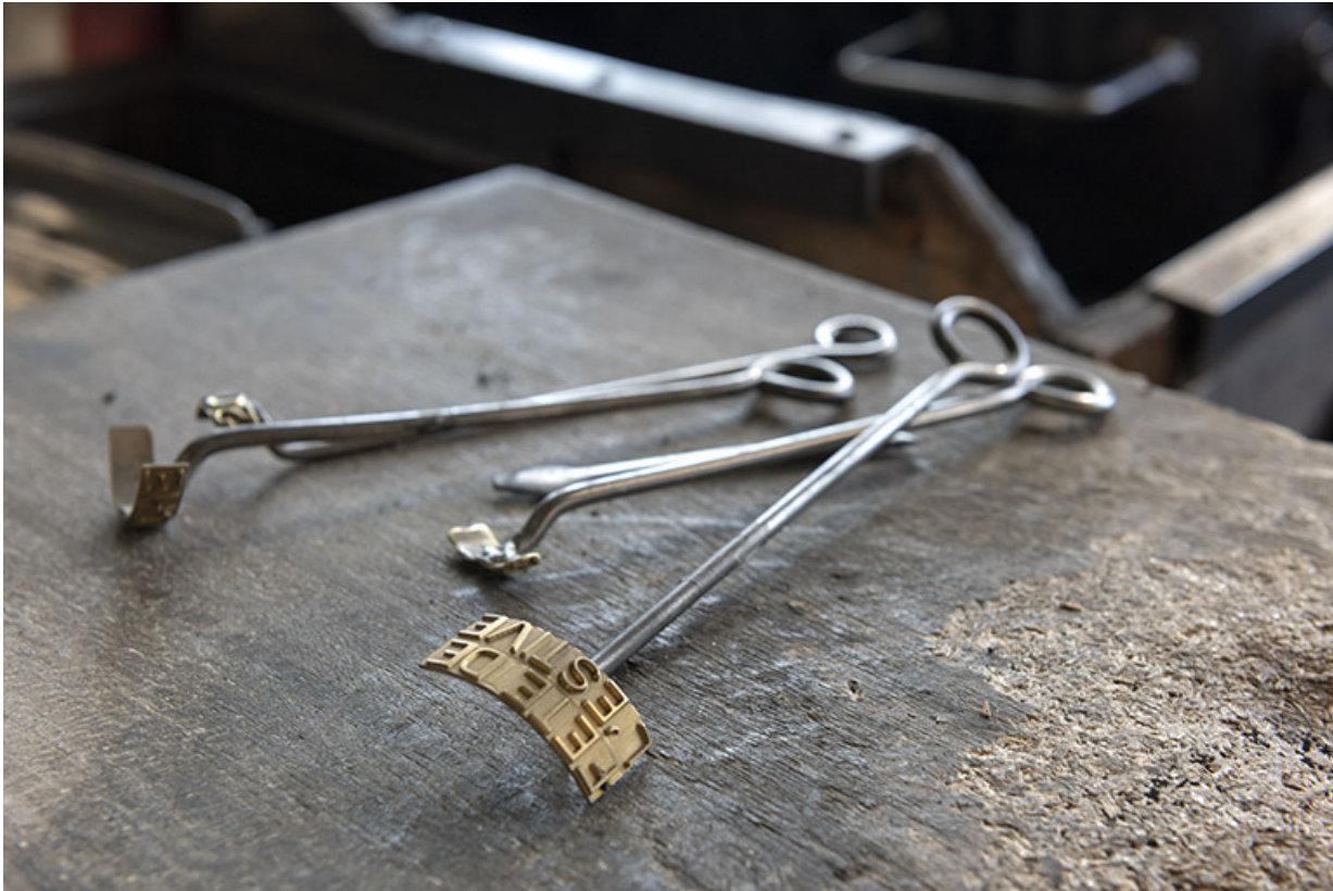
Fabrication du moule : outils servant à imprimer les inscriptions.
