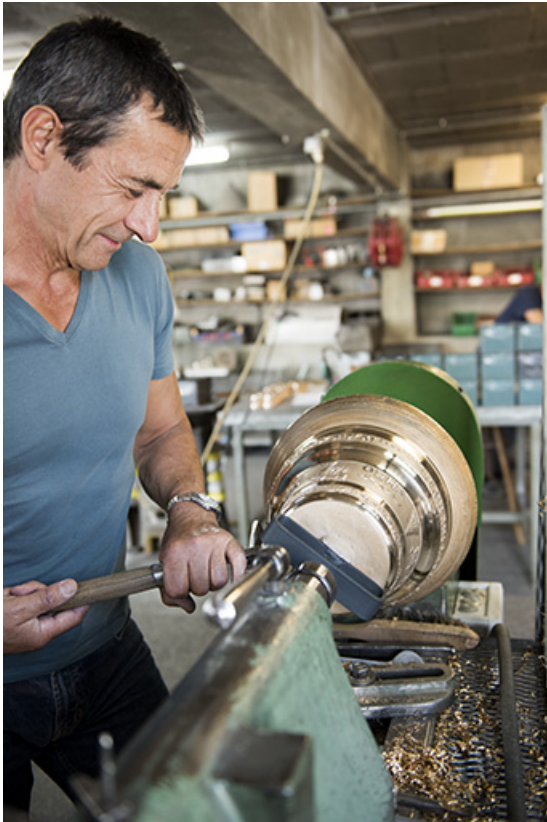
Tournage d'une cloche : geste de l'ouvrier.
