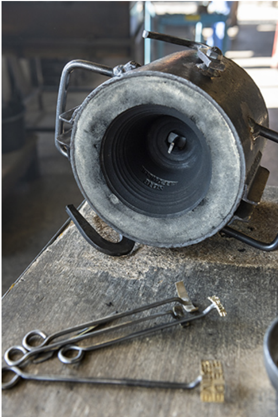
Fabrication du moule : moule en creux avec inscription et outils.
