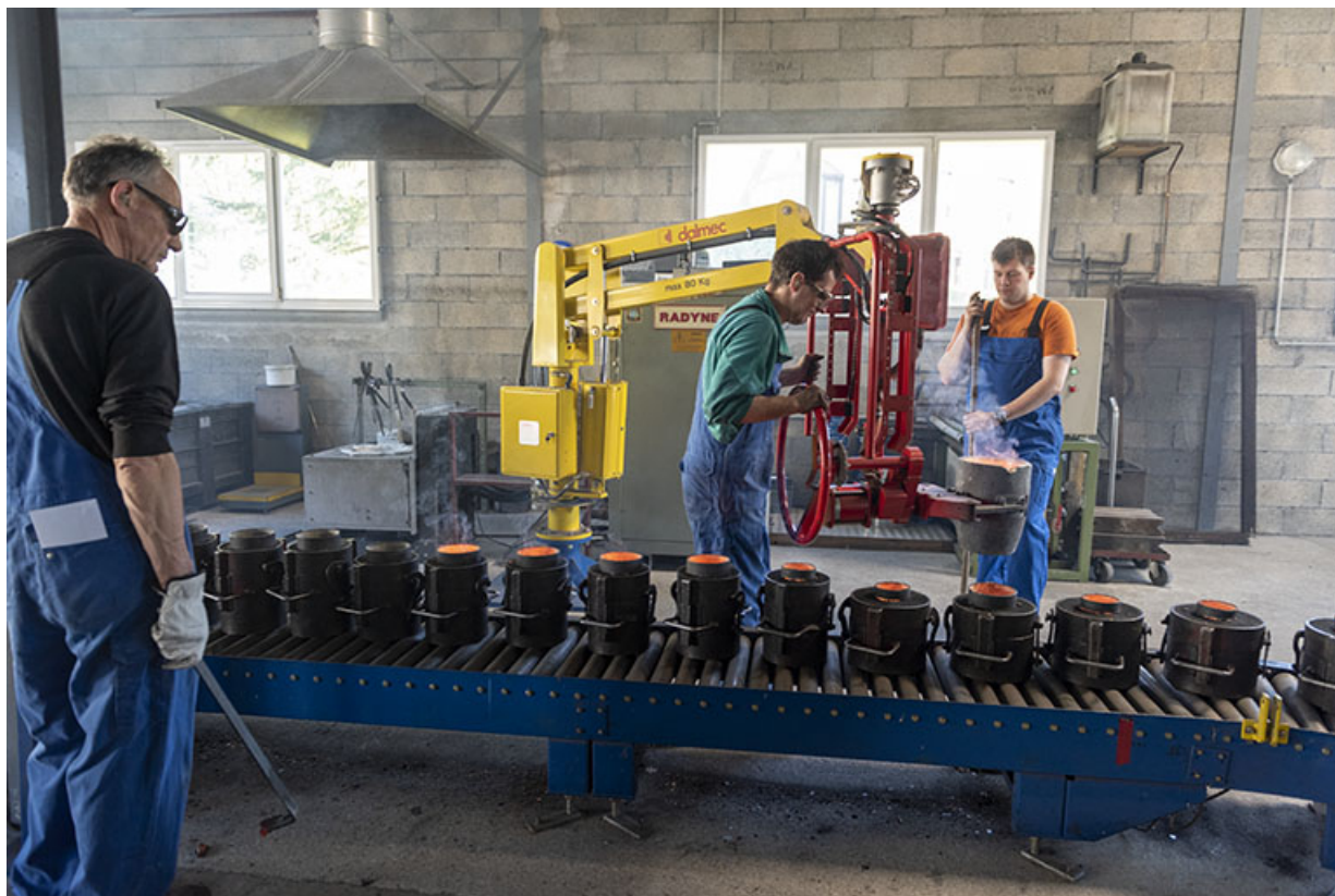
Coulée : déplacement de la poche de métal. 25, Les Fins, 4 route de Morteau
