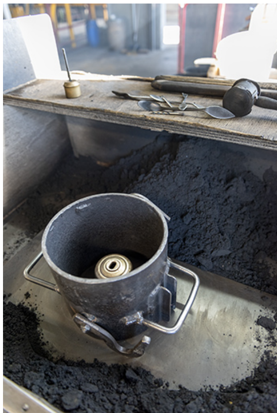
Fabrication du moule : le modèle dans son châssis.
