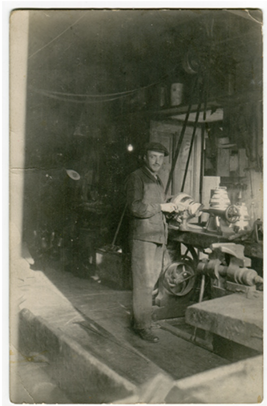
[Tournage d'une cloche par Jean Obertino], décennie 1930. 25, Les Fins, 4 route de Morteau
