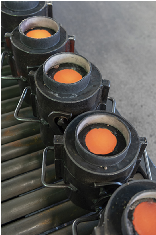
Refroidissement du bronze dans des petits châssis.
