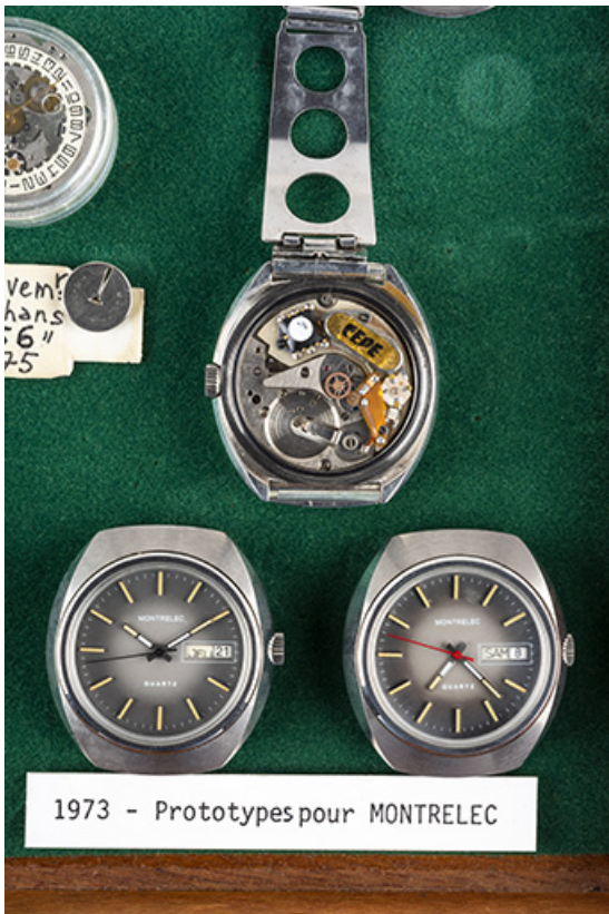
Prototypes de montres à quartz étudiés par le Cetehor pour Montrelec (1973). (Collection Cetehor, Besançon). 25, Besançon, 39 avenue de l' Observatoire
