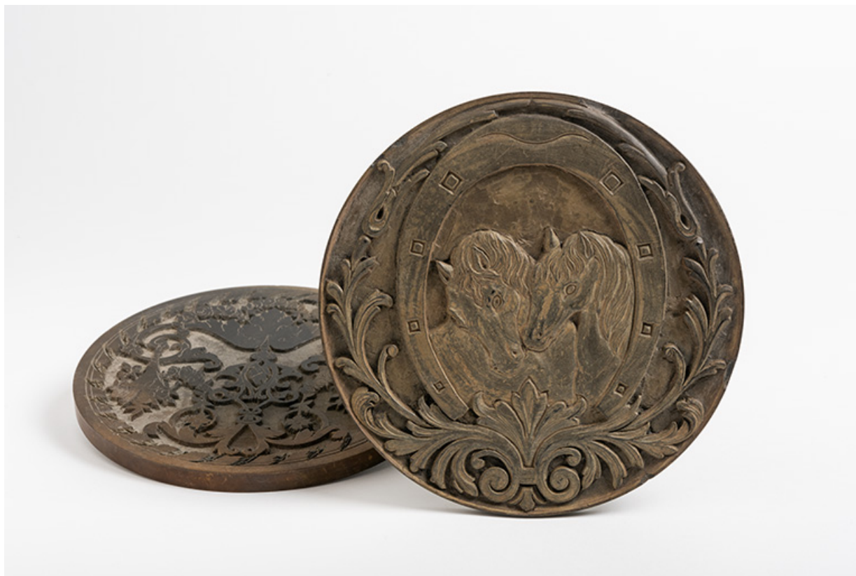
"Patrones" pour machine à guillocher. (Collection musée de l'Horlogerie, Morteau). 25, Morteau, 30 rue de la Chaussée
