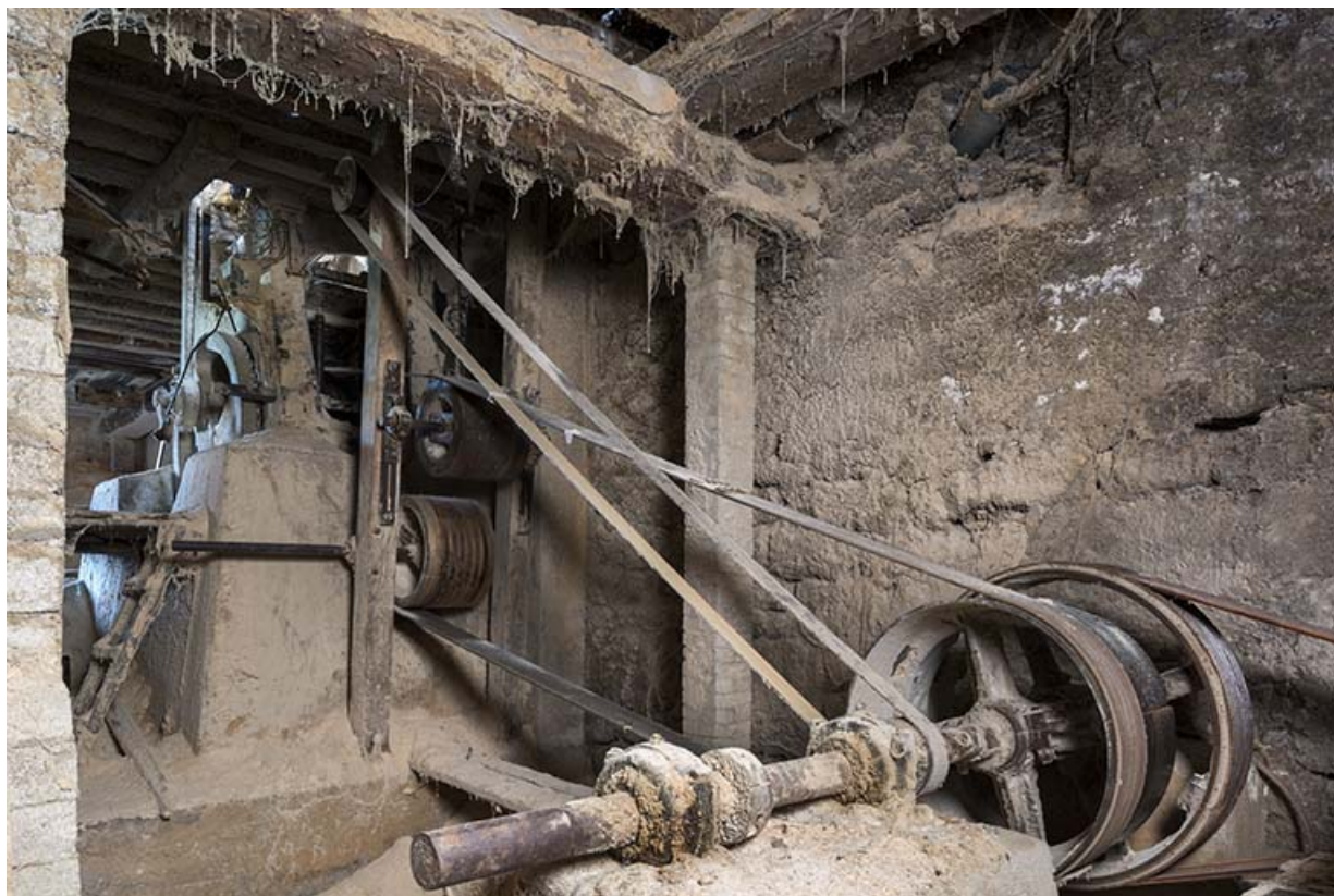
Atelier de fabrication, sciurier : transmission (poules et courroies) du châssis Socolest. 25, Montlebon, 13 rue du Moulin, lieudit : Cornabey
