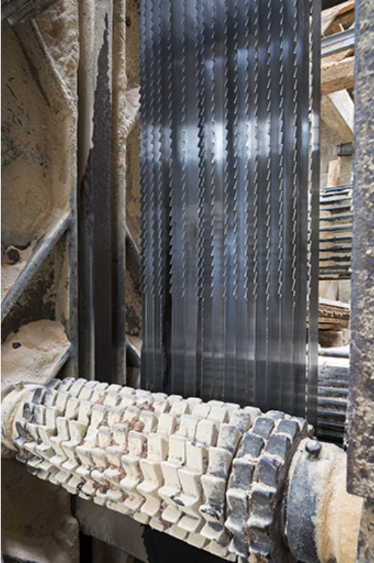
Atelier de fabrication : châssis de scie Socolest, rouleau et lames.
