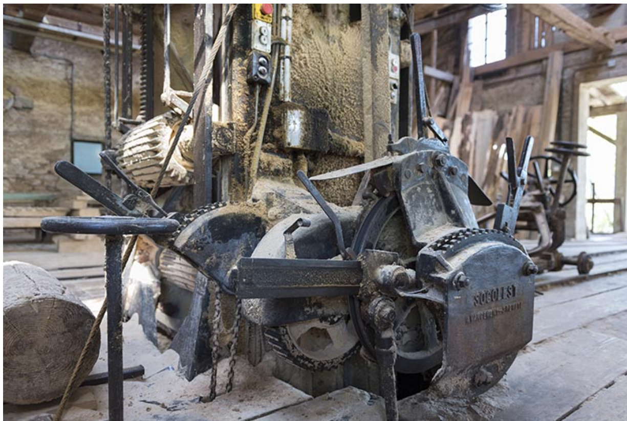
Atelier de fabrication : châssis de scie Socolest, détail du système moteur. 25, Montlebon, 13 rue du Moulin, lieudit : Cornabey
