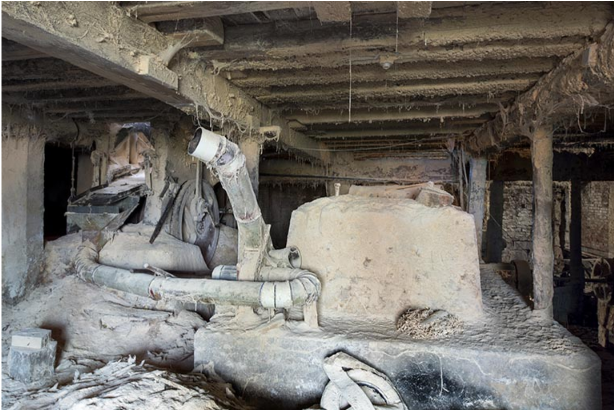
Atelier de fabrication, sciurier : massifs en maçonnerie de la scie Socollest (à gauche) et d'un châssis démonté. 25, Montlebon, 13 rue du Moulin, lieudit : Cornabey
