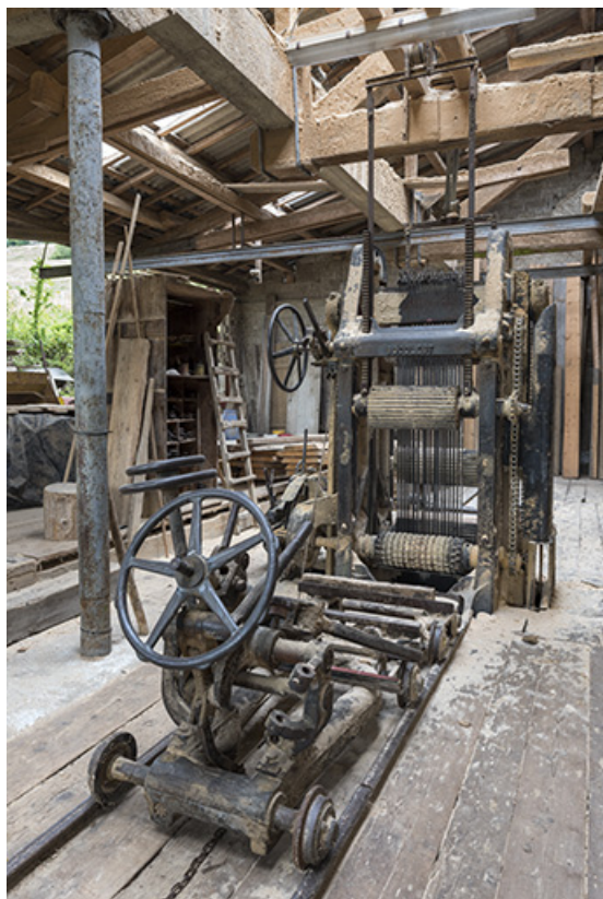
Atelier de fabrication : châssis de scie Socolest. 25, Montlebon, 13 rue du Moulin, lieudit : Cornabey
