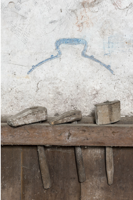
Atelier de fabrication : maillets de dinandier et dessin de couvercle.
