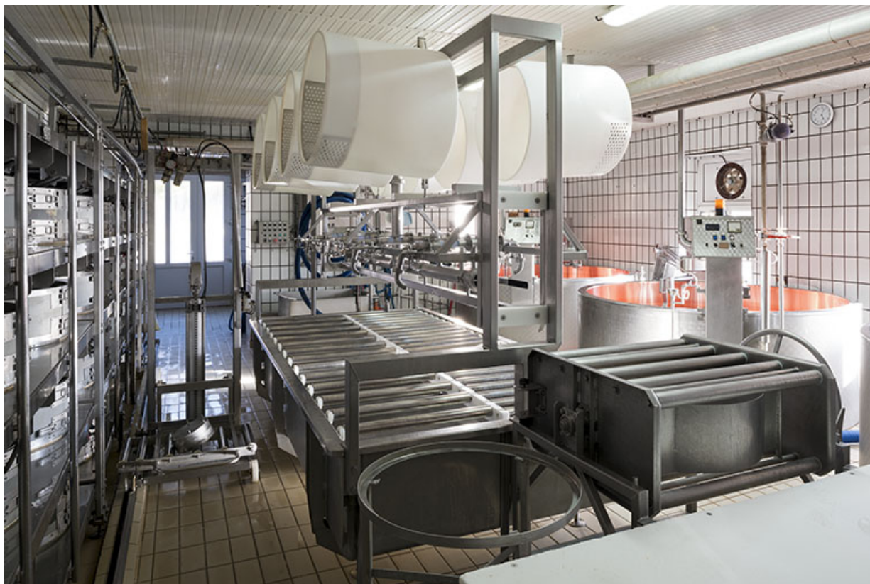
Atelier de fabrication : vue d'ensemble avec le répartiteur du groupe de soutirage par pompe à caillé. 25, Montlebon, Fruitière rue de la 6
