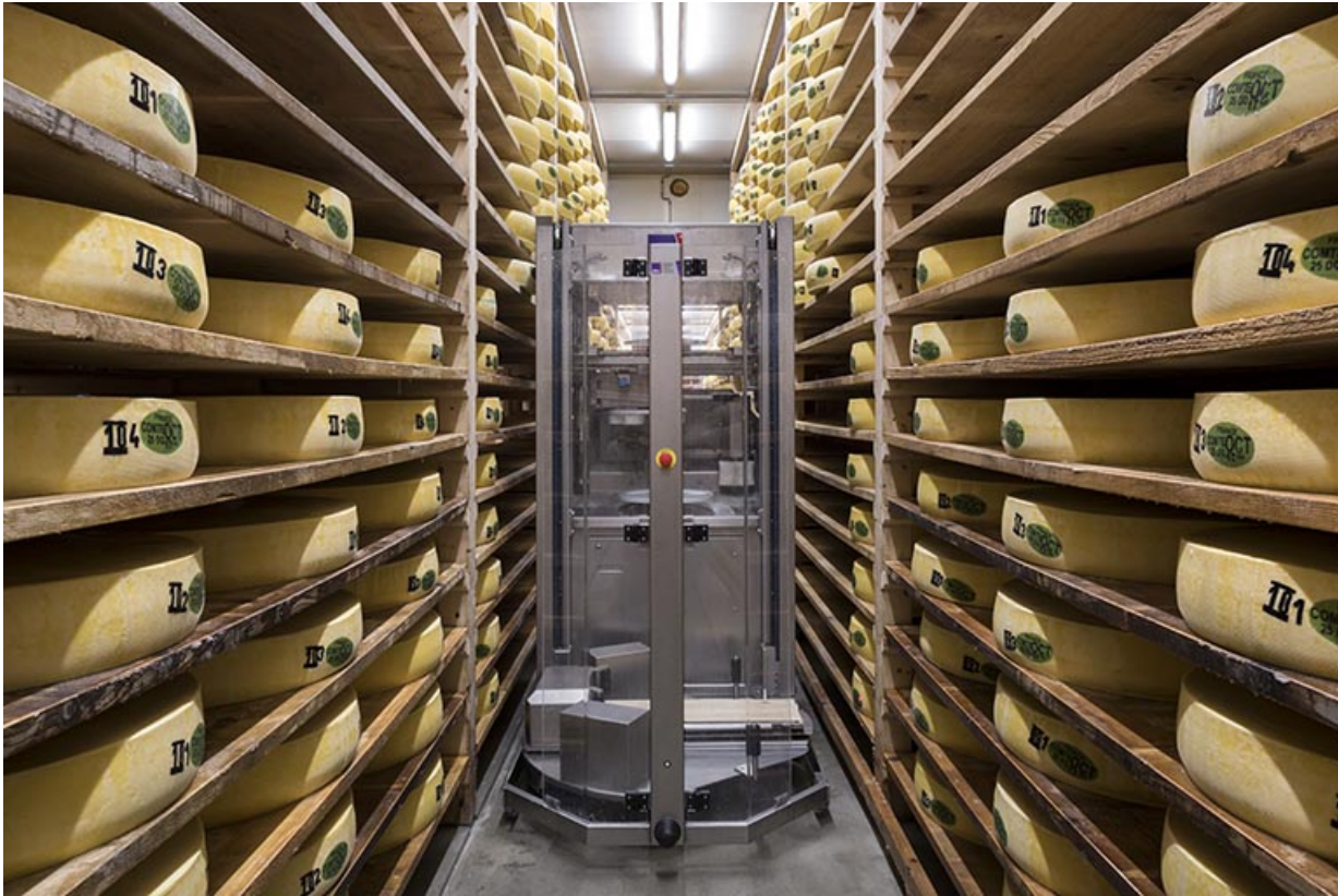
Cave d'affinage : meules de comté et robot de soin JNJ Automation.
