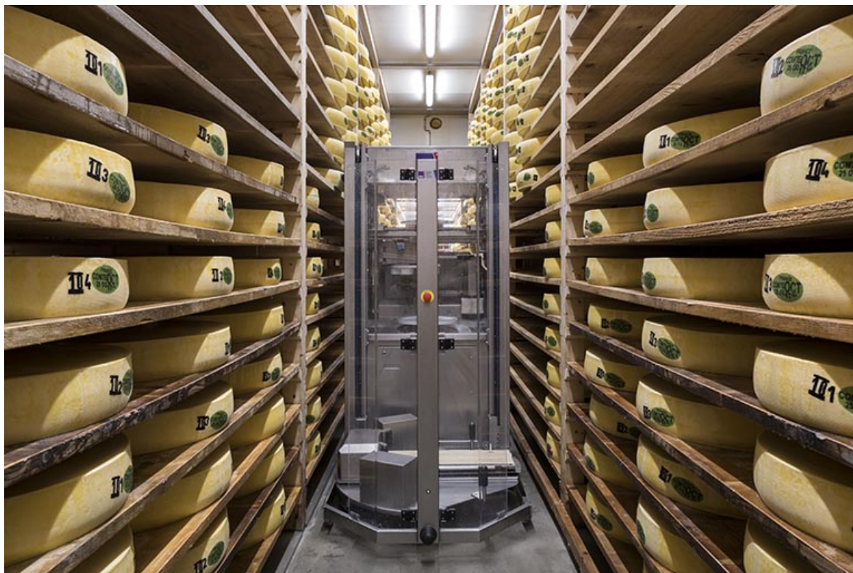
Cave d'affinage : meules de comté et robot de soin JNJ Automation. 25, Montlebon, Fruitière rue de la 6
