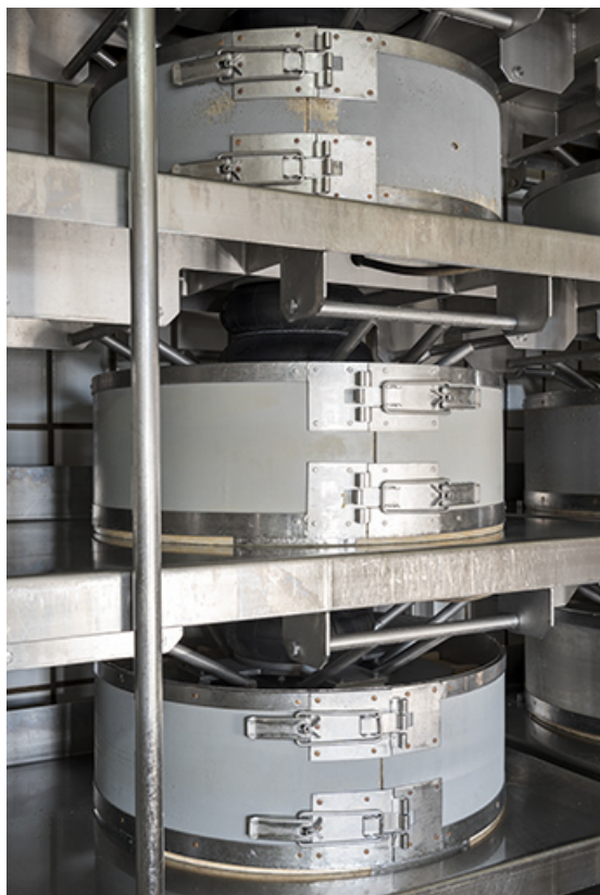
Atelier de fabrication : trois moules dans l'installation de pressage. 25, Montlebon, Fruitière rue de la 6
