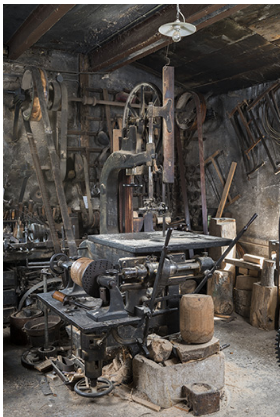
Forge : scie à ruban et mortaiseuse Mougeotte (Melay, Haute-Marne). 25, Grand'Combe-Châteleu, lieudit : les Cordiers
