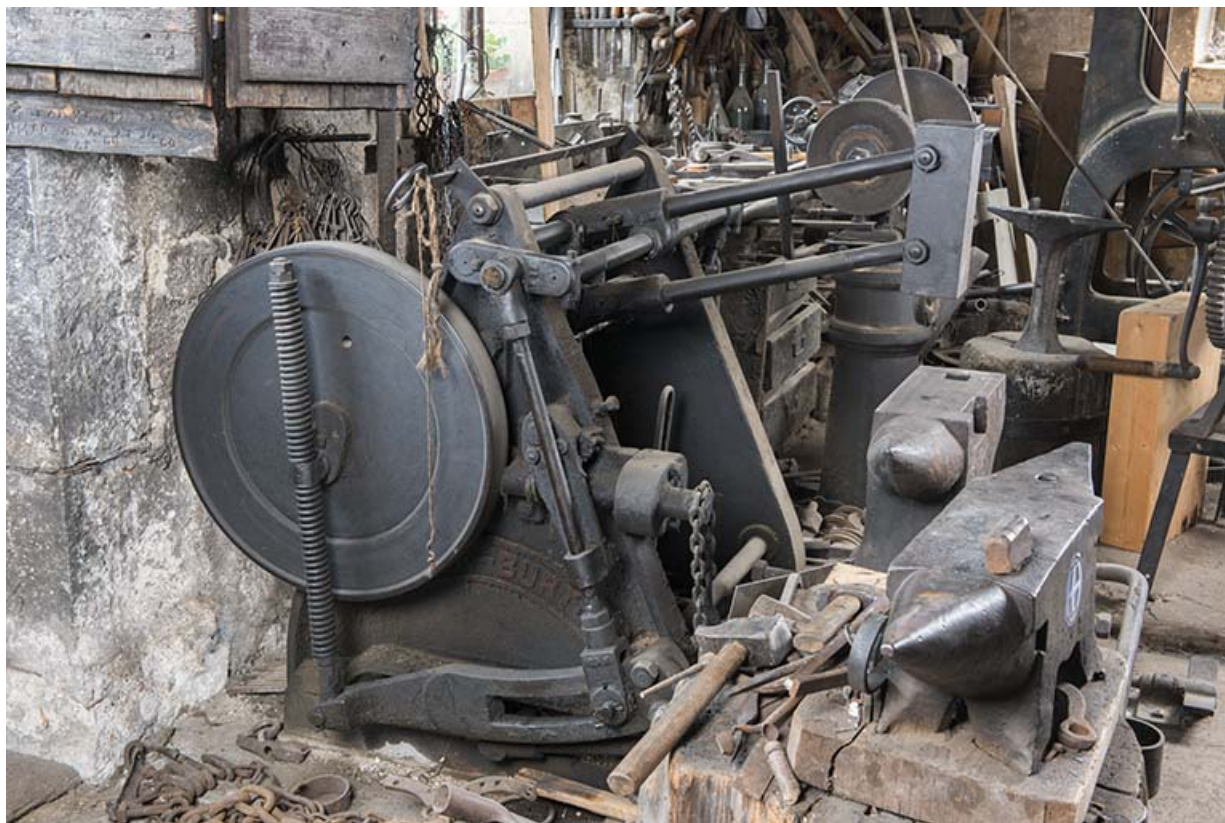
Forge : frappeur mécanique (ou marteau mécanique) Blake & Burton.
