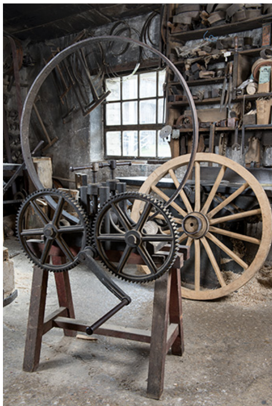
Forge : grande cintreuse Groperrin (Besançon). 25, Grand'Combe-Châteleu, lieudit : les Cordiers
