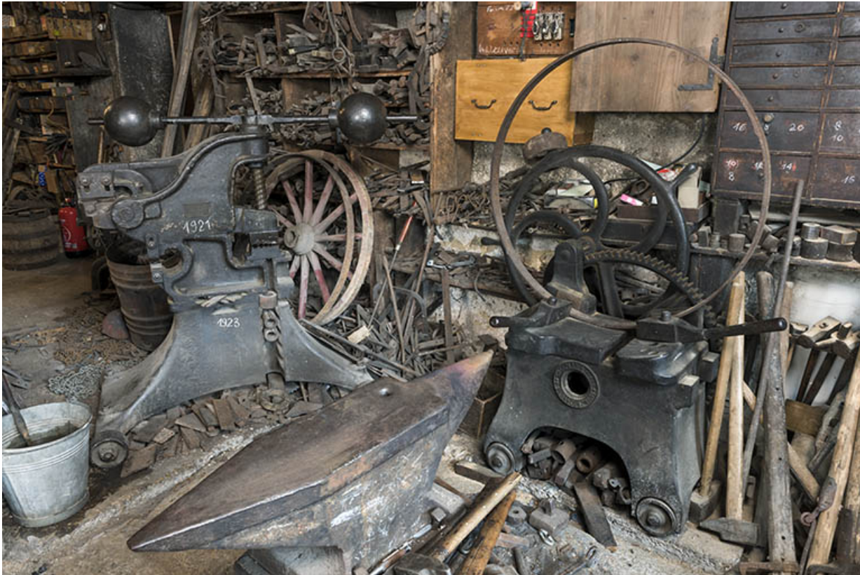
Forge : enclume, cisaille à balancier A. Vernet (Dijon) et refouleuse Jules Gersperrin (Besançon). 25, Grand'Combe-Château, lieudit : les Cordiers
