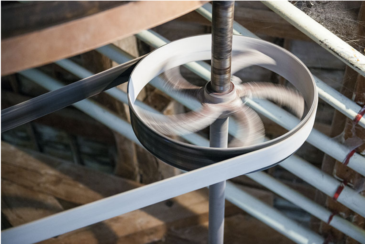
Troisième étage. Poulie et courroie du plansichter.
