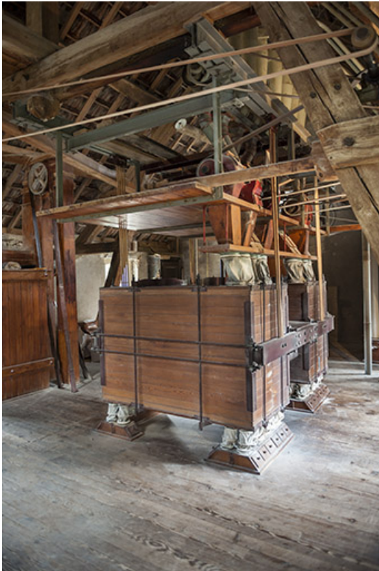
Troisième étage. Plansichter double Nehlig, Heuser et Cie.
