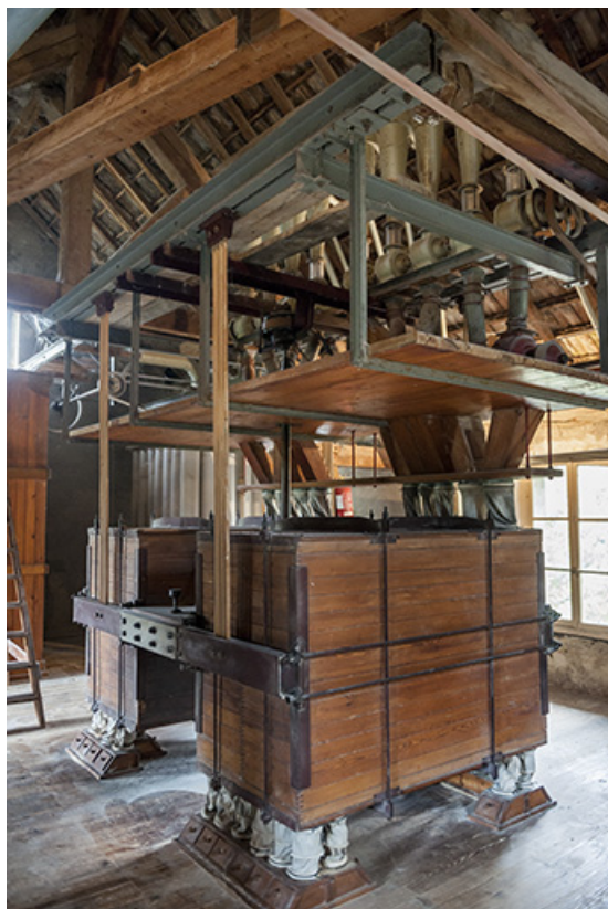
Troisième étage. Plansichter Nehlig, Heuser et Cie vu de trois quarts. 25, Liesle, lieudit : le Moulinot
