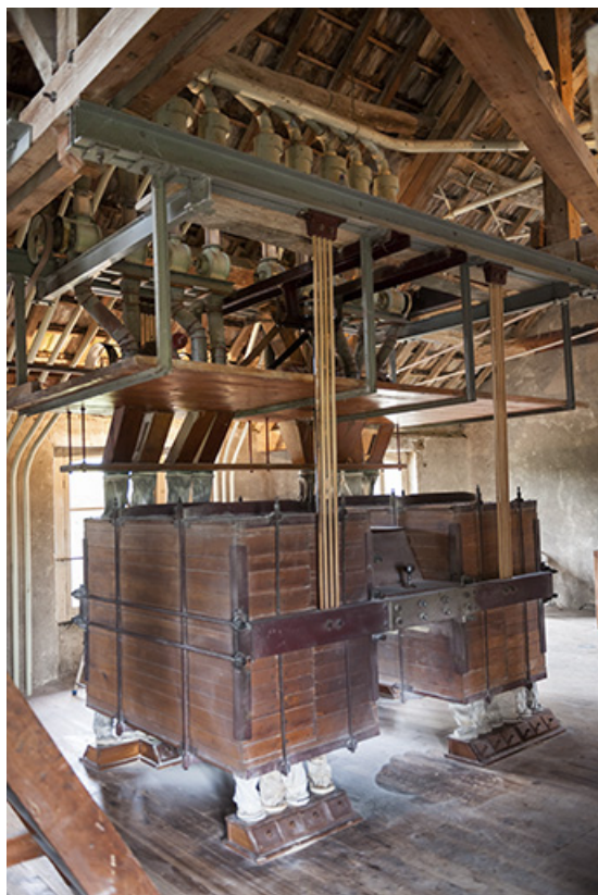
Troisième étage. Vue d'ensemble du plansichter double Nehlig, Heuser et Cie. 25, Liesle, lieudit : le Moulinot
