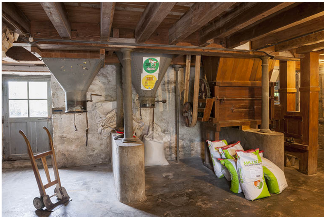
Rez-de-chaussée. Poste d'ensachage et mélangeuse.
