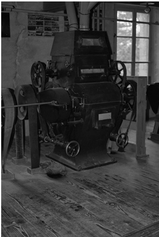
Vue intérieure : broyeuse.
