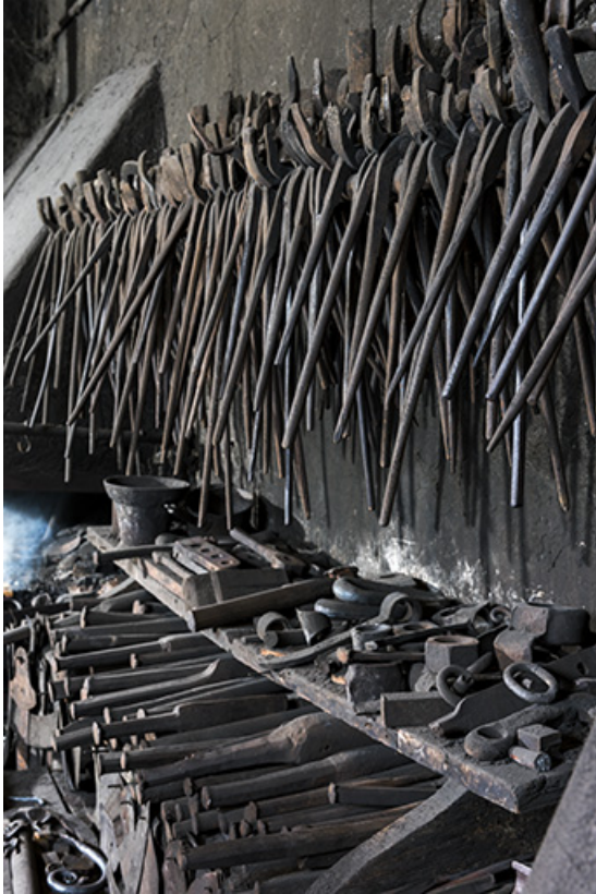
Forge : intérieur de l'atelier de travail à chaud (pinces de forgeron et outils). 25, Grand'Combe-Châteleu, 5-9 Pré Rondot
