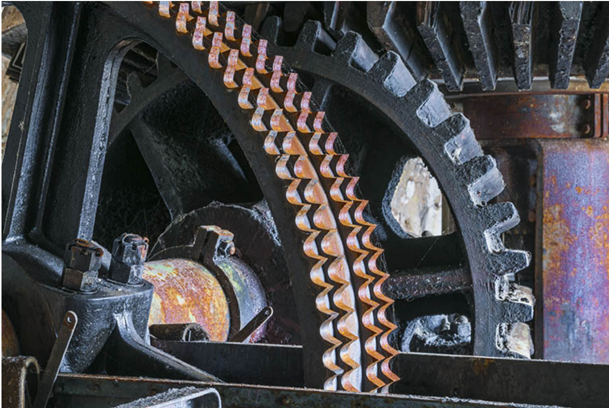
Rez-de-chaussée de l'atelier principal. Détail du mécanisme d'entraînement (engrenages coniques et roues dentées pour chaînes). 25, Geneuille route des Papetiers
