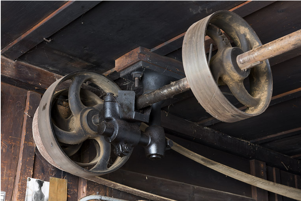
Atelier : transmission au plafond.
