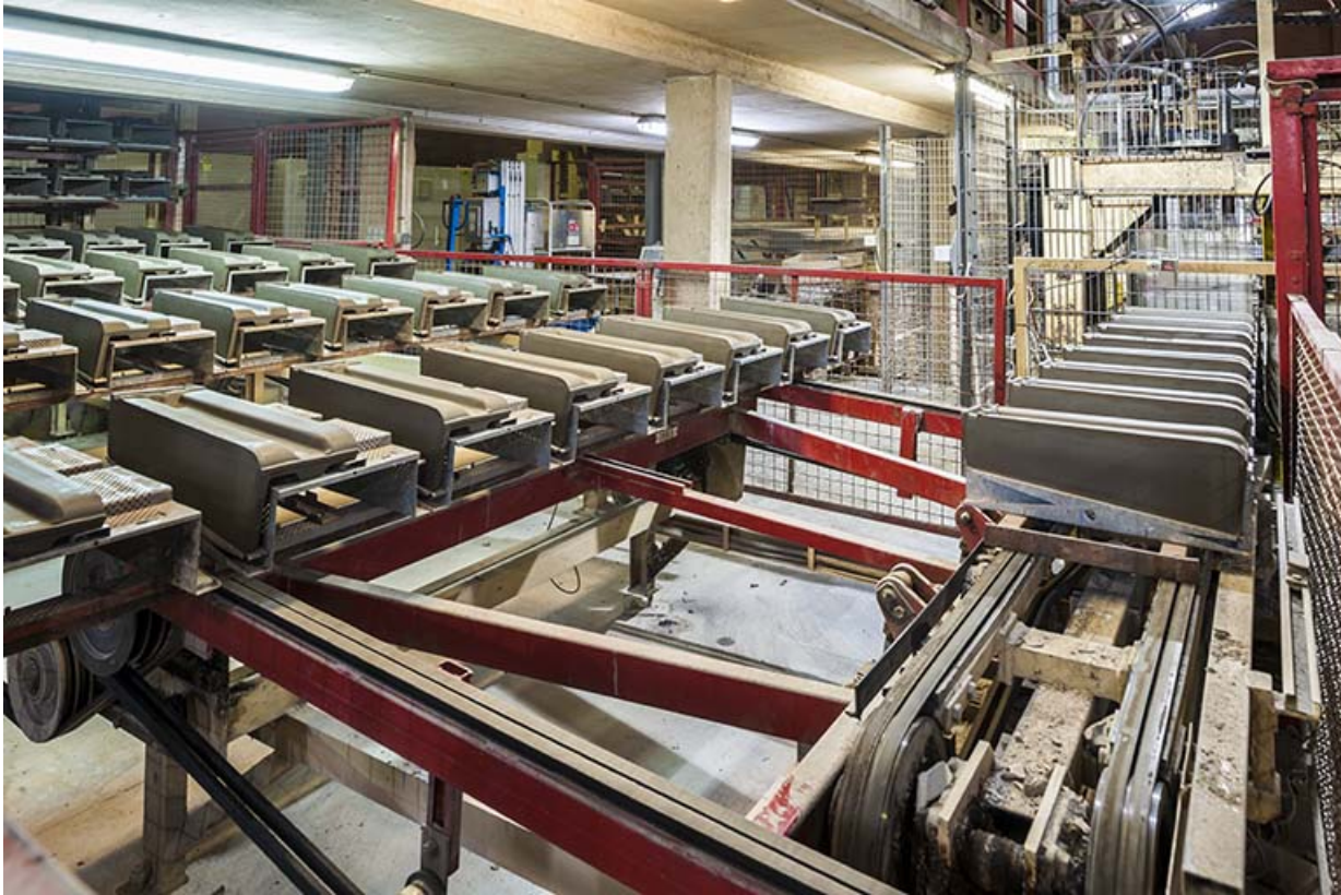
Tuiles en sortie de la mouleuse.
