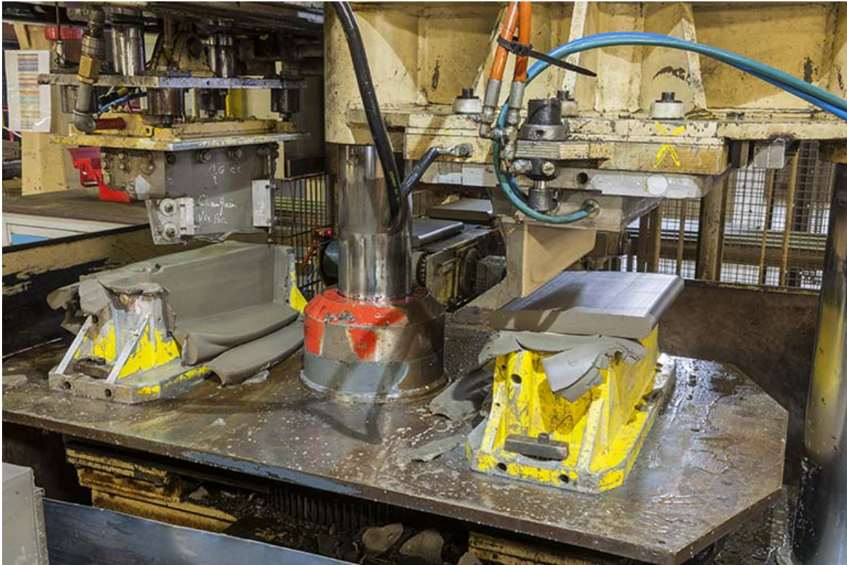
Unité de fabrication dite UL 3. Détail de la machine de pressage (deux têtes). 25, Lantenne-Vertière route de Mercey
