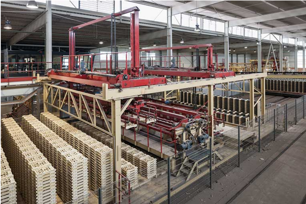
Unité de fabrication dite UL 5. Poste d'empilage-dépilage des tuiles sur supports réfractaires. 25, Lantenne-Vertière route de Mercey
