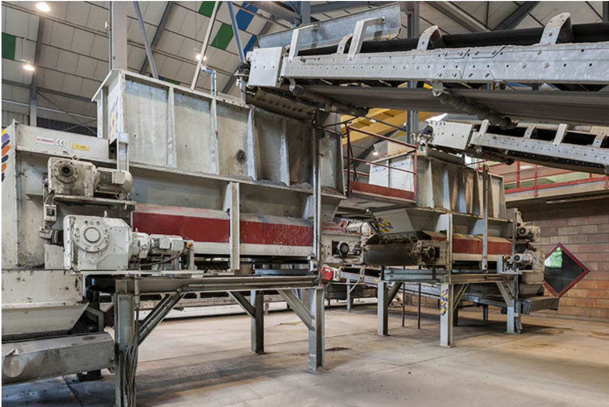
Unité de préparation des terres. Doseurs-tampon.
