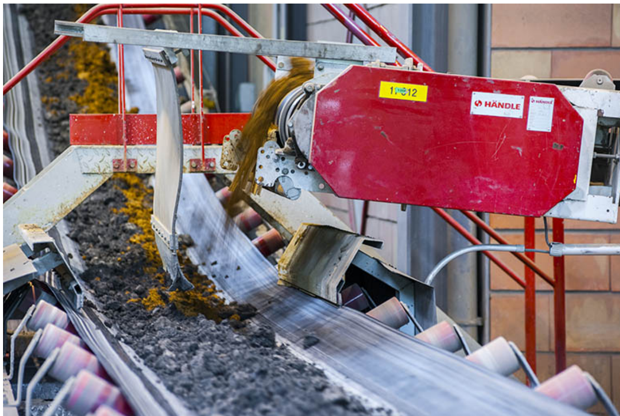
Unité de préparation des terres. Mélange des terres sur le transporteur à bande. 25, Lantenne-Vertière route de Mercey
