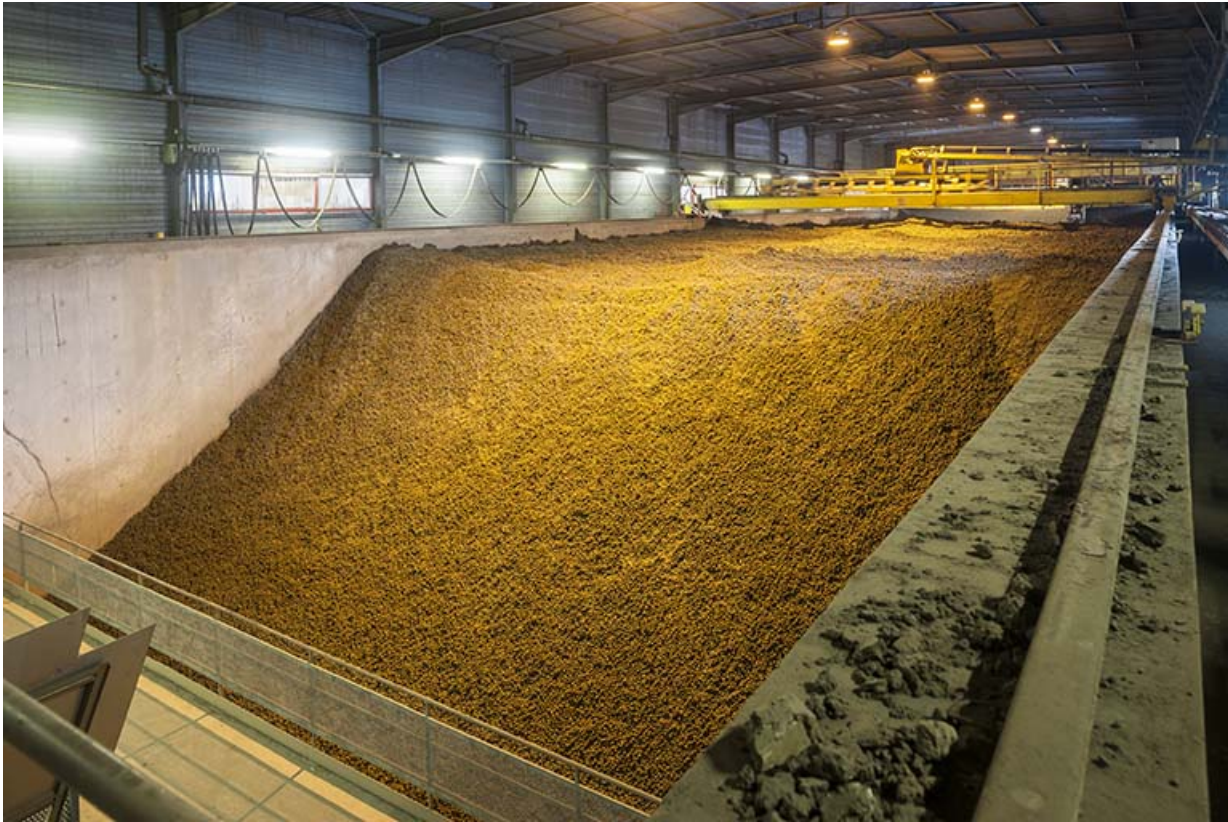
Fosse à terre (homogénéisation, maturation). Vue d'ensemble.
