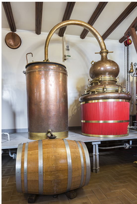
Alambic de 390 litres : cucurbite et chapiteau (à droite), col de cygne, réfrigérant (à gauche) et tonneau de réception du distillat. 25, Pontarlier, 49 rue des Lavaux
