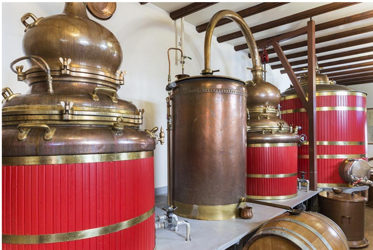
Alambics. Vue rapprochée des cucurbites et réfrigérants.
