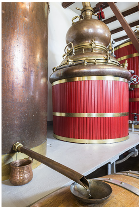
Distillation en cours. Ecoulement du distillat du réfrigérant.
