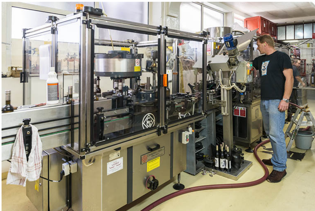
Unité de conditionnement (embouteillage, pose du bouchon et de la capsule, étiquetage). 25, Pontarlier, 49 rue des Lavaux
