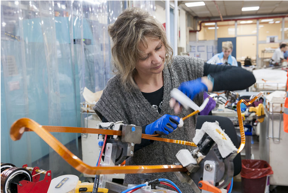
Isolation manuelle des barres de cuivre.
