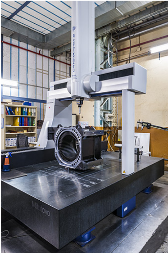
Contrôle tridimensionnel sur marbre.
