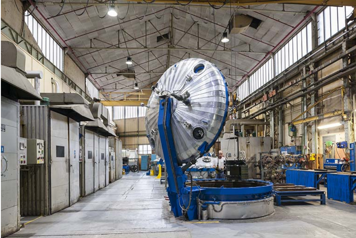
Atelier d'imprégnation (autoclave ouvert).
