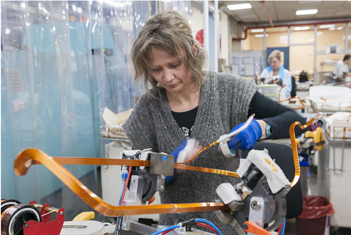
Isolation manuelle des barres de cuivre.
