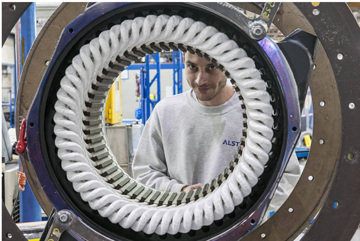
Atelier de bobinage. Montage des barres de cuivre sur un stator.
