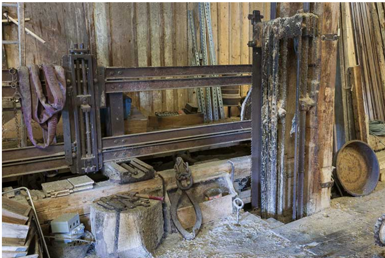
Châssis vertical monolame dit "sabre".
