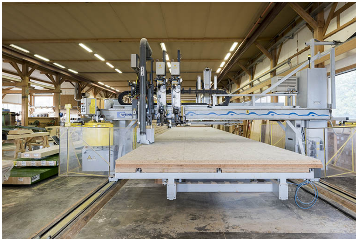
Nouveau site, atelier de fabrication : pont multifonctions à commandes numériques Weinmann WMS 150.
