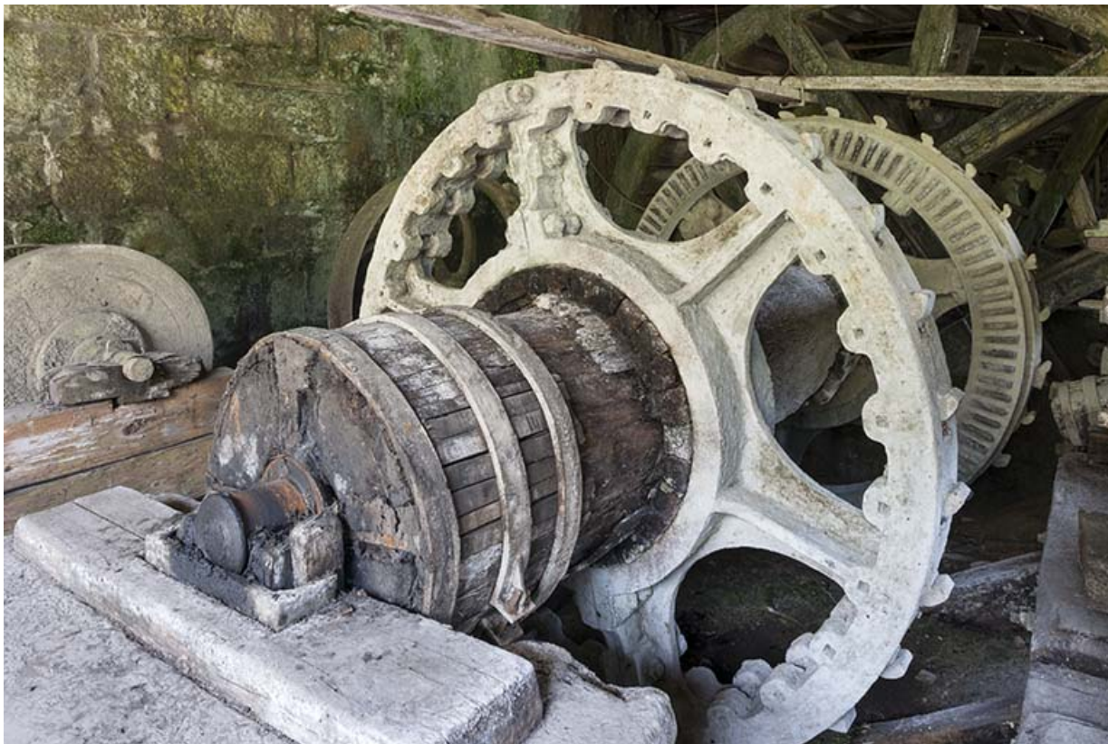
Arbre de couche de la roue hydraulique. Au second plan, roue dentée actionnant un polissoir. 25, Nans-sous-Sainte-Anne rue du Four
