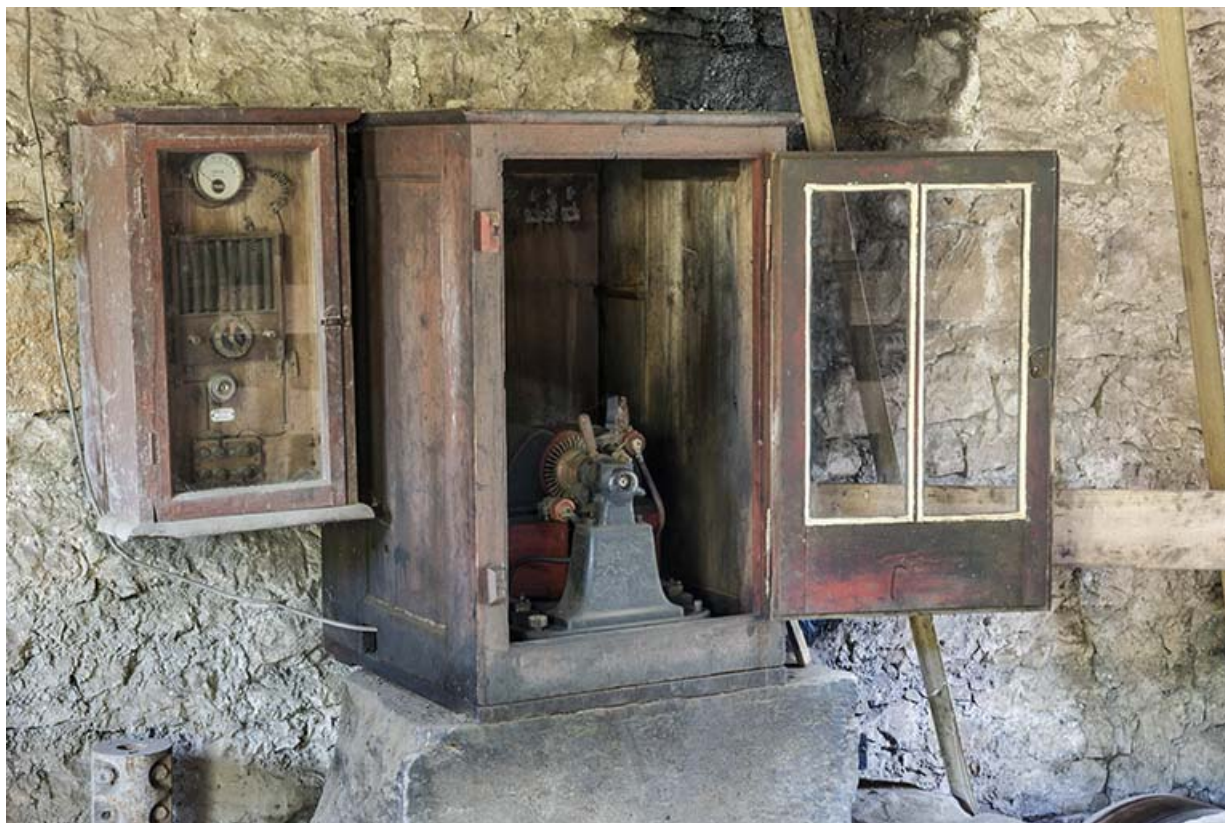
Machine Gramme (pièce de la machine soufflante.)
