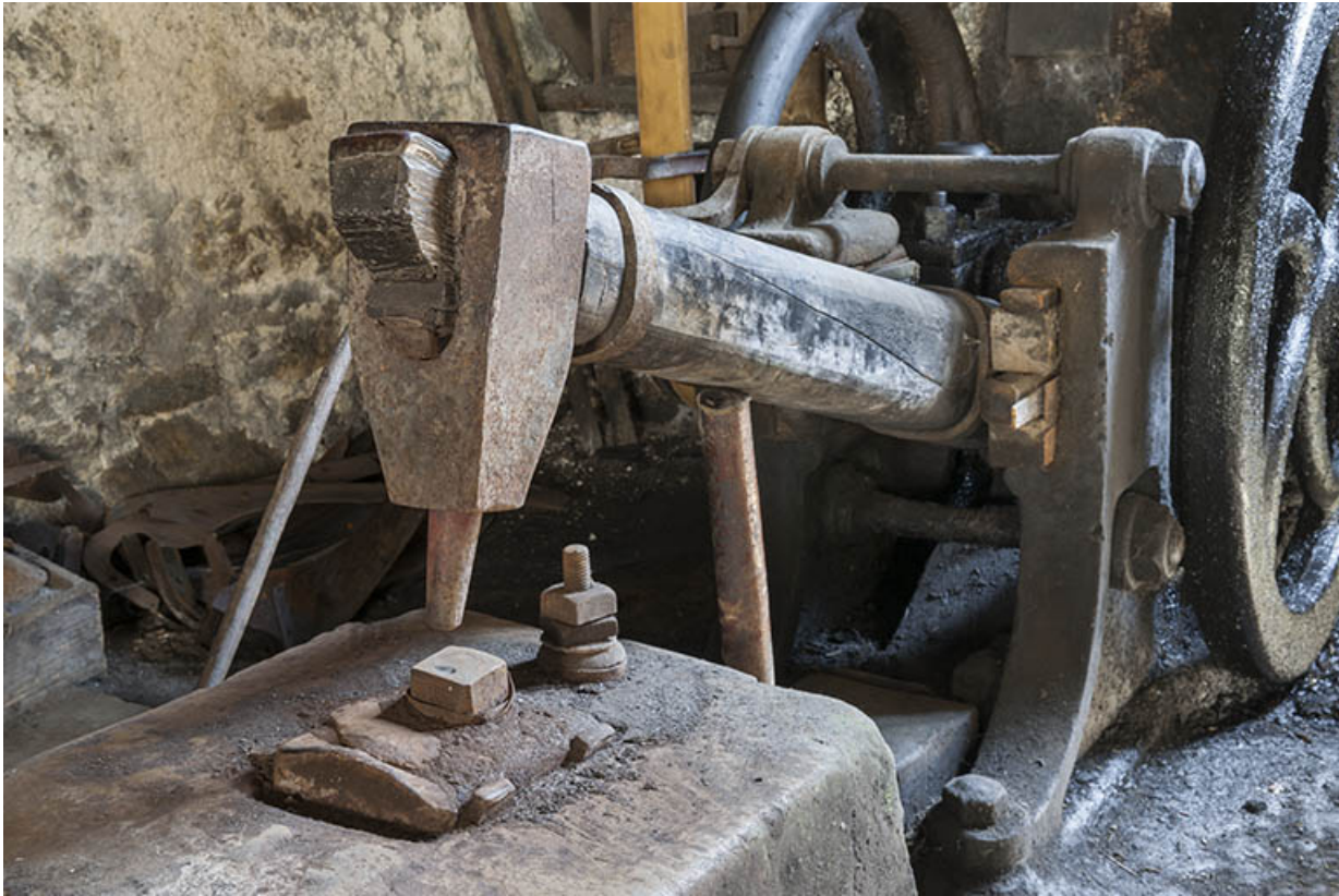
Atelier de mécanique. Détail de la tête du martinet de finition. 25, Nans-sous-Sainte-Anne rue du Four
