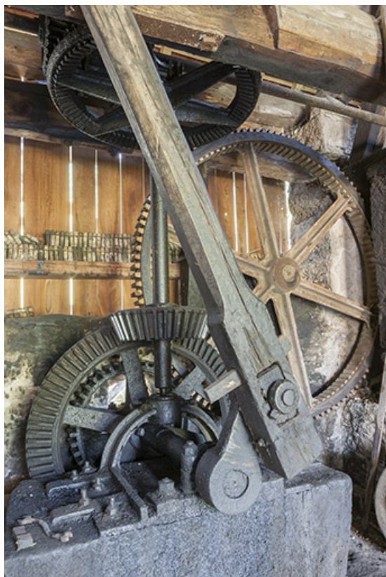
Mécanisme de transmission par bielle.
