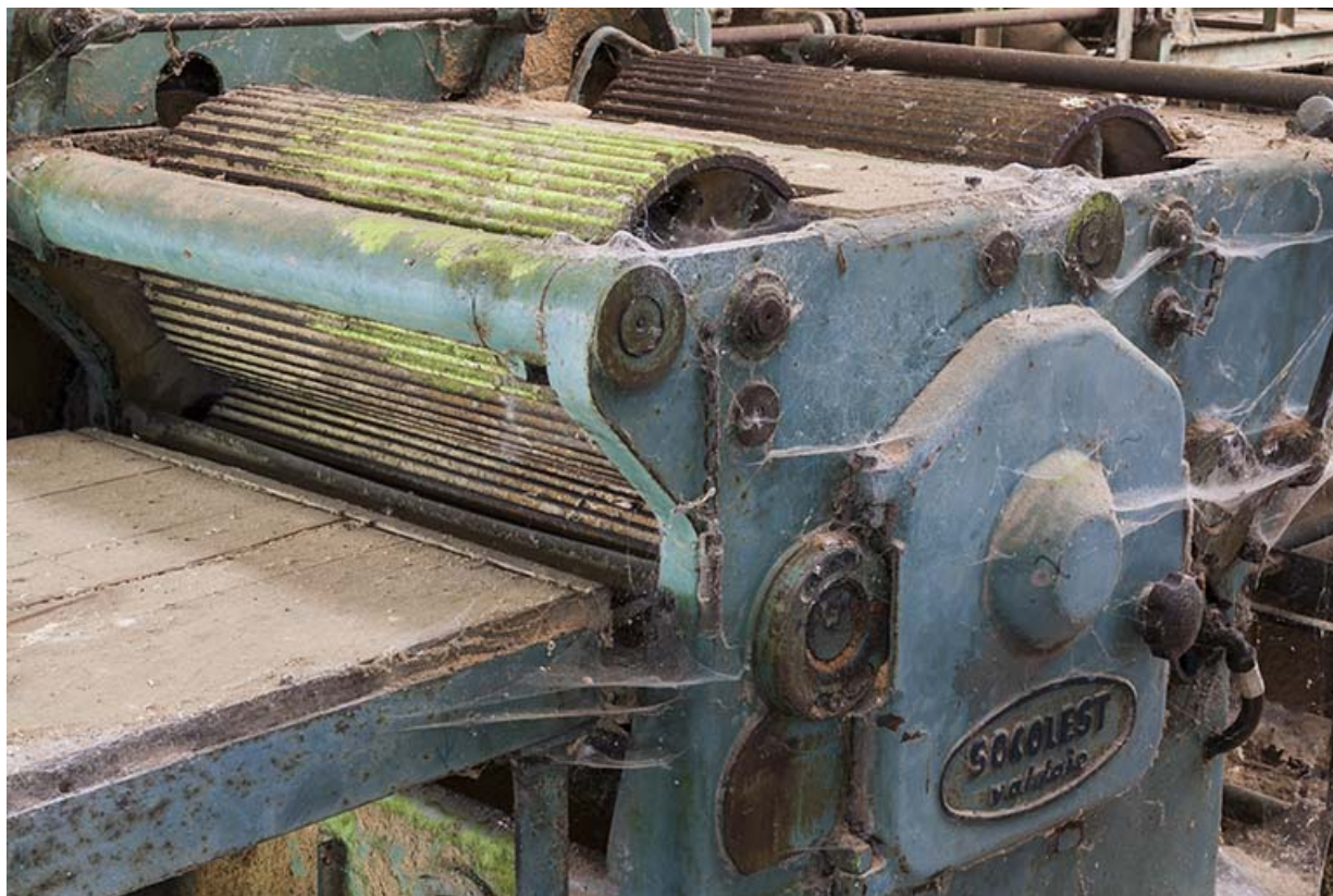
Déligneuse. Détail des rouleaux cannelés.
