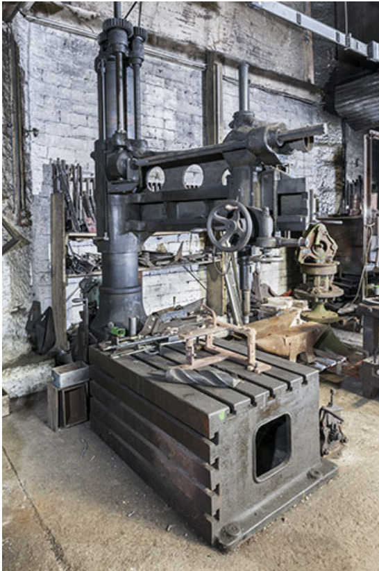
Machine à aléser (perceuse radiale).
