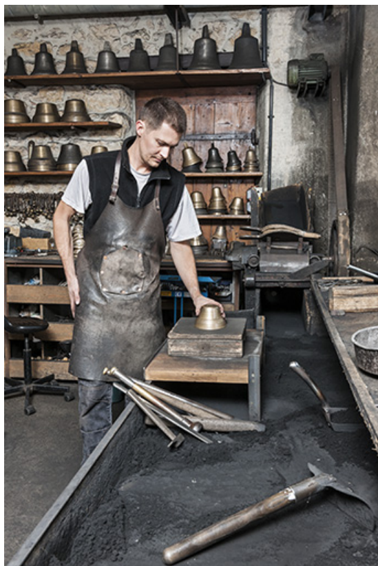
Moulage. Positionnement du modèle (donne l'empreinte extérieure).
