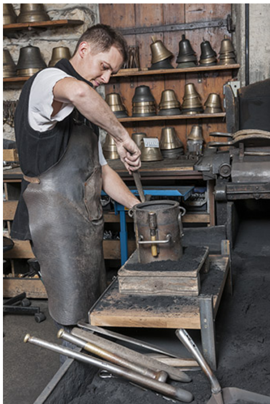
Moulage. Pose de la partie supérieure du châssis. 25, Labergement-Sainte-Marie, 15 rue de la Fonderie
