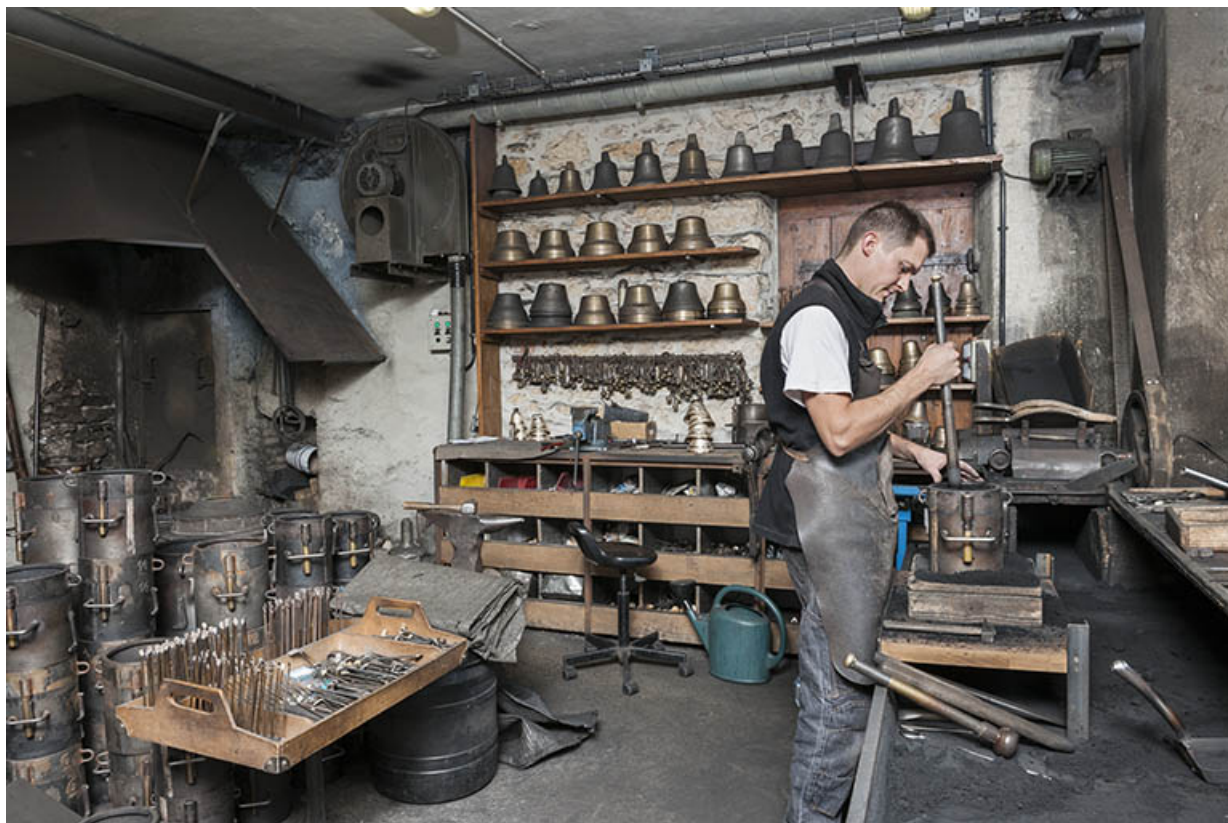
Moulage. Tassage du sable dans la partie supérieure du châssis.
