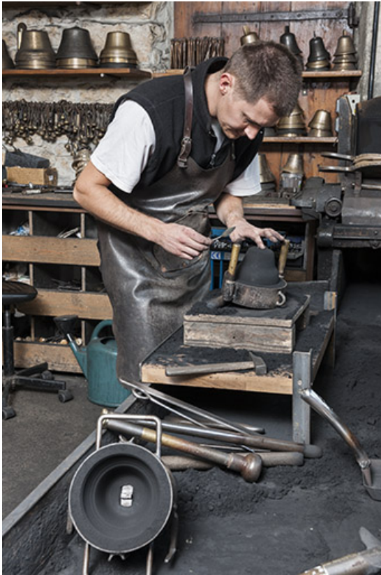
Moulage. Finition (perçement d'orifices pour l'attache du battant). 25, Labergement-Sainte-Marie, 15 rue de la Fonderie
