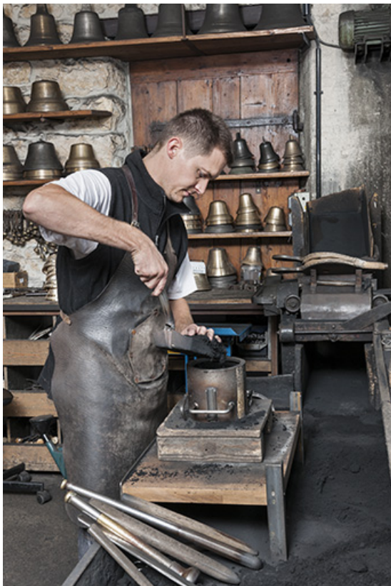
Moulage. Le châssis est complété après tassage. 25, Labergement-Sainte-Marie, 15 rue de la Fonderie
