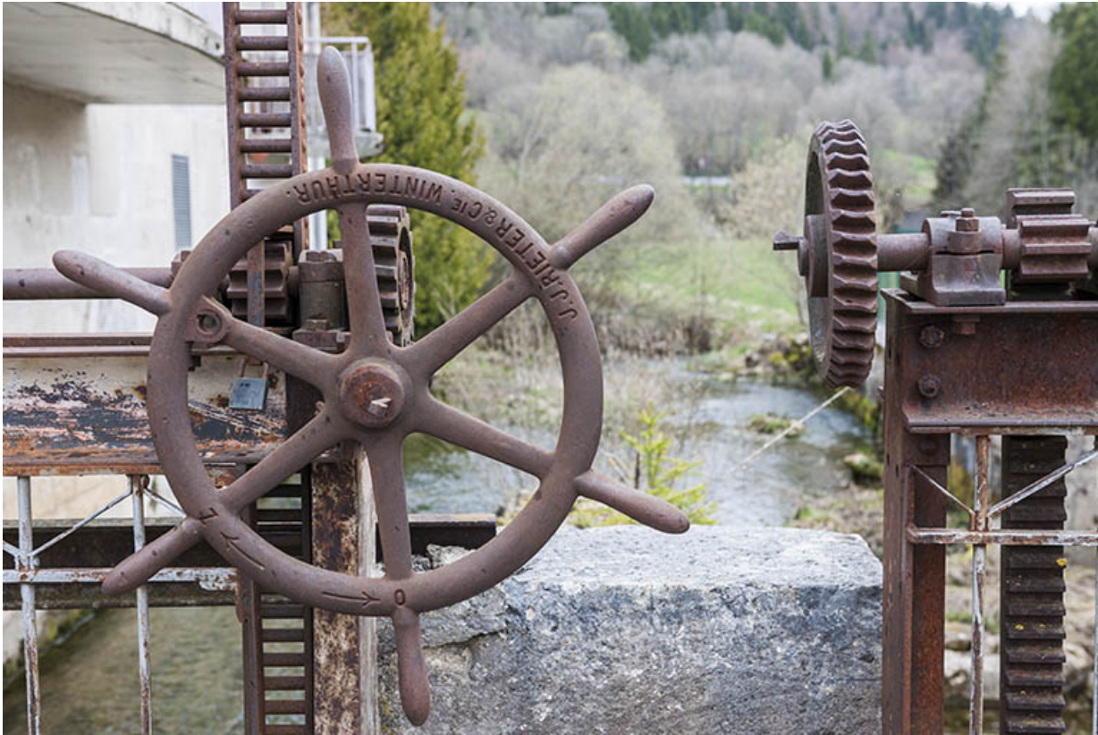
Détail du mécanisme du vannage.
